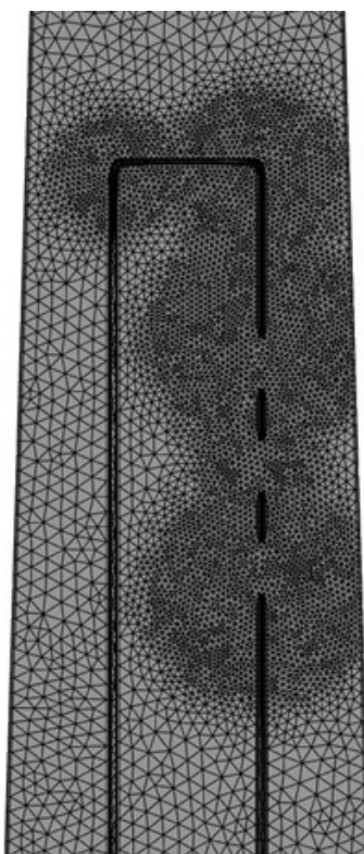
Slika 5.3 Detalj omrežene geometrije irigacijske igle s tri otvora
