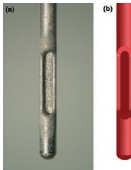
Slika 4.4 Usporedba igle s modeliranom geometrijom [6]
