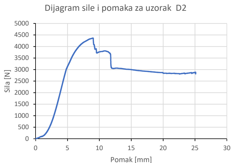
Slika 3.7 Dijagram sile i pomaka mjereno na kidalici za polimernu pjenastu jezgru gustoće 80 \text{ kg/m}^3 na uzorku s ugljičnim vlaknima i epoksidnom matricom - D2.
