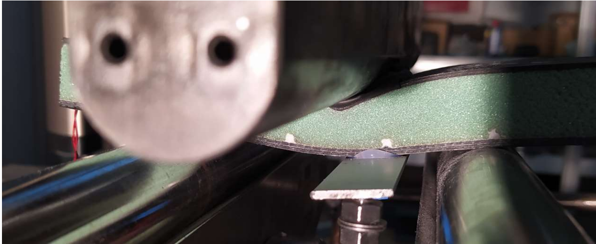
Slika 3.6 Utiskivanje glave kidalice u slojeve vanjskog laminata za polimernu pjenastu jezgru gustoće 80 \text{ kg/m}^3 na uzorku s ugljičnim vlaknima i epoksidnom matricom - D2.
