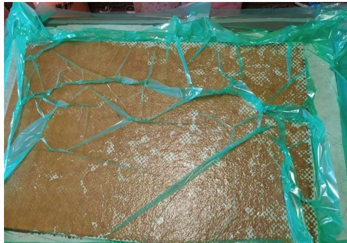
Slika 3.3 Prikaz izrade uzoraka od E stakla i vinilesterske matrice upotrebom postupka vakuumiranja mokrog laminata (engl. vacuum bagging )
