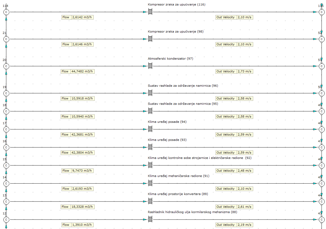
Slika 5.7. Model kruga slatke vode niske temperature, detalj
