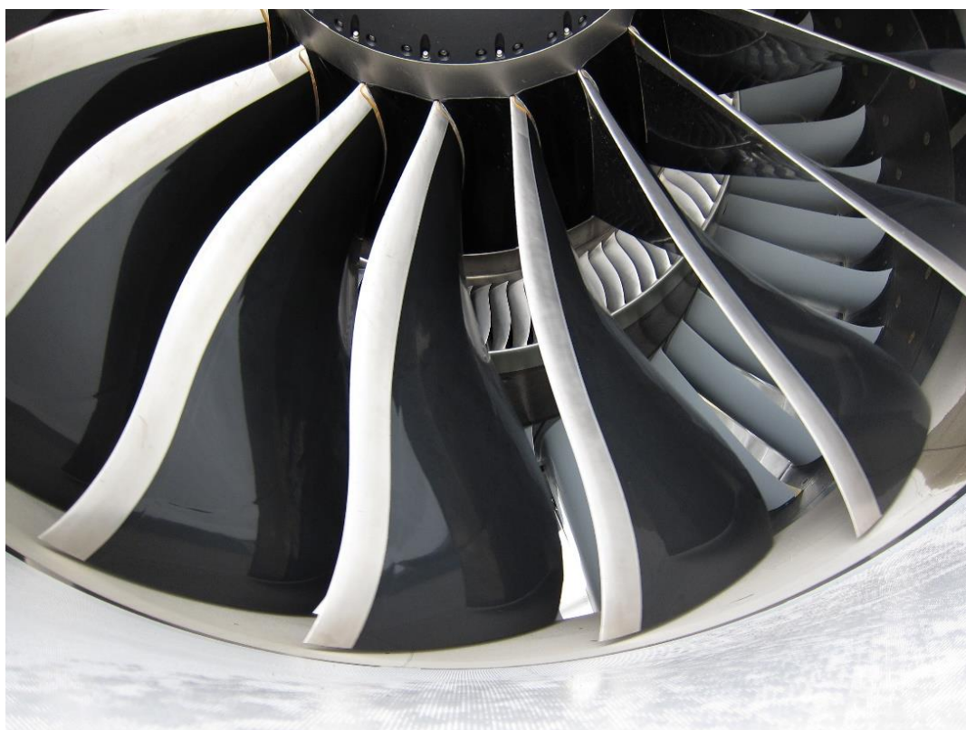
Slika 13 Lopatice turbine GENx motora
