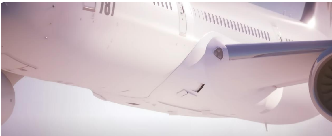
Slika 21 Ulazi za zrak na trupu zrakoplova [4]
