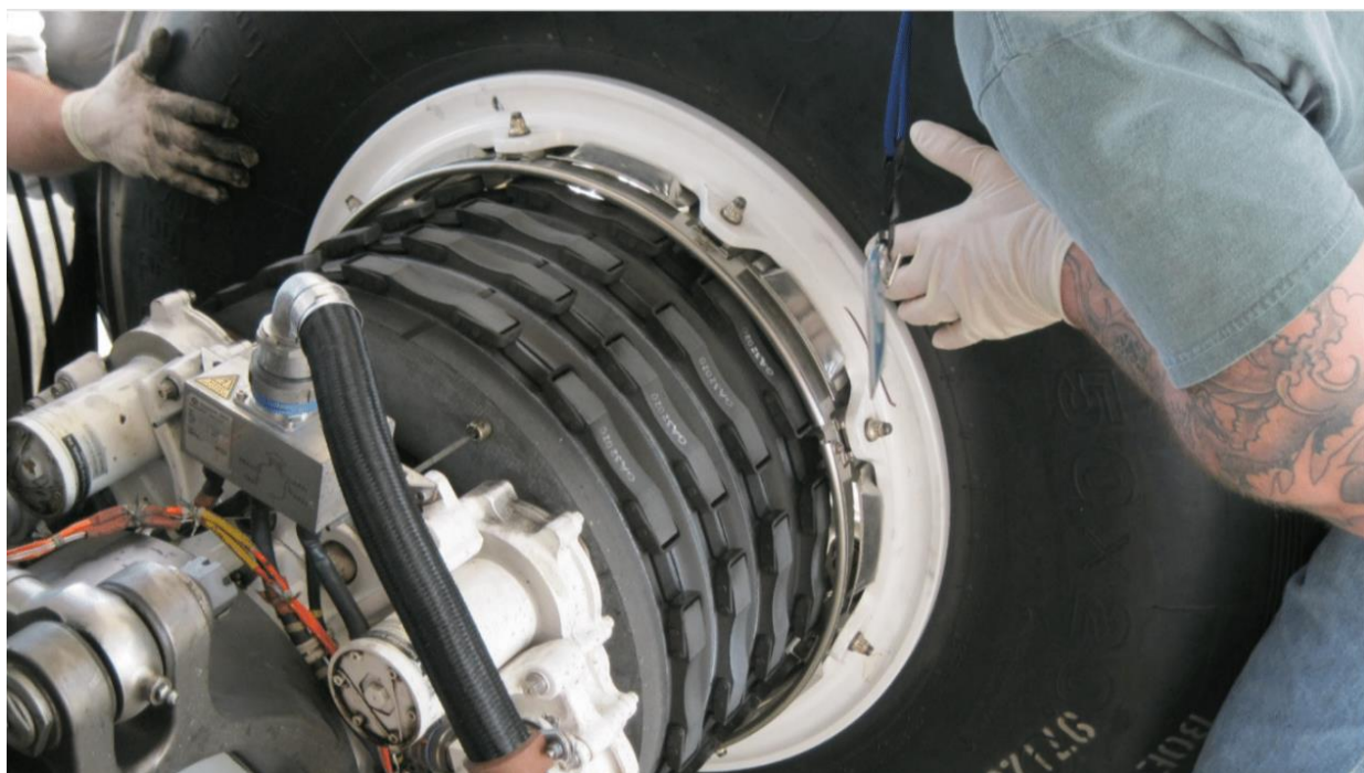
Slika 22 Sustav kočenja na Boeingu 787 [3]
