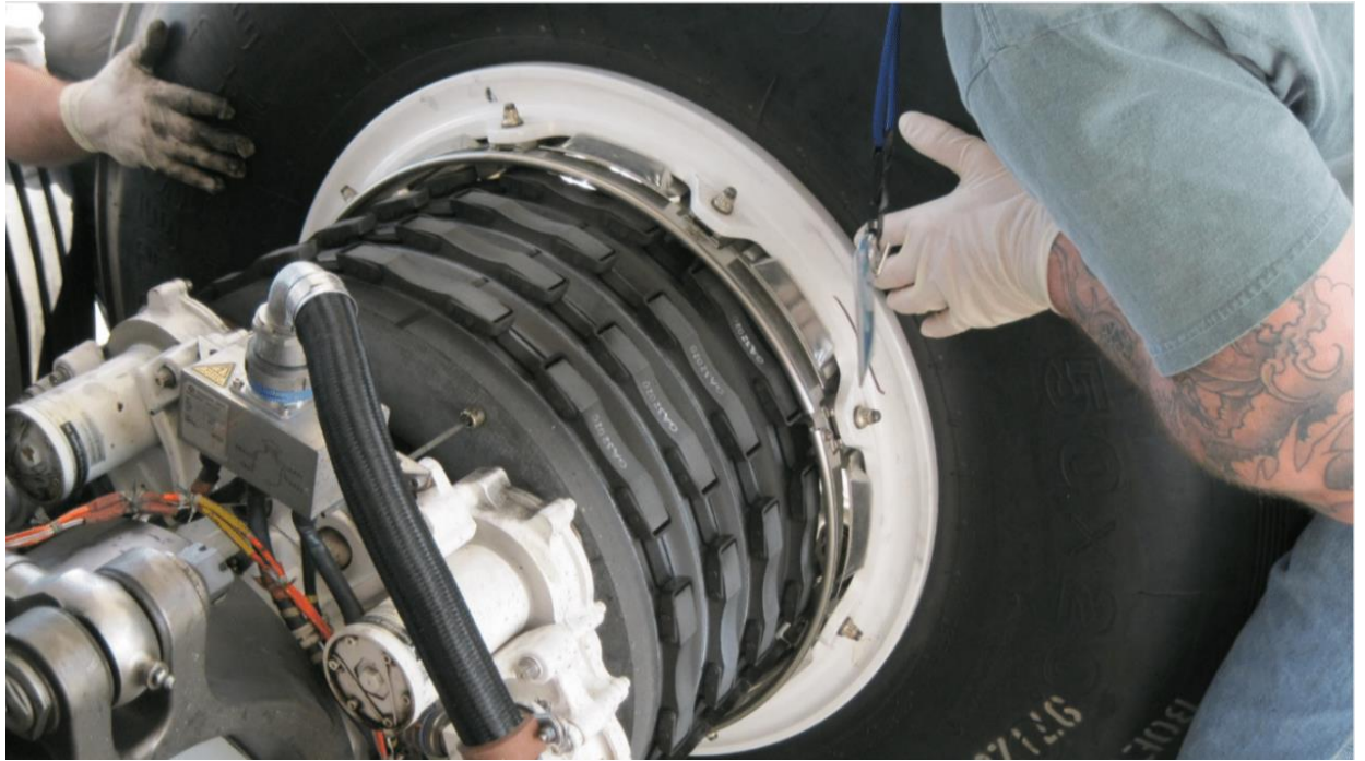
Slika 22 Sustav kočenja na Boeingu 787 [3]
