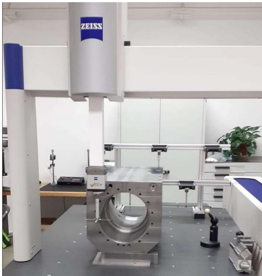
Slika 4.13. Mjerenje kućišta trokoordinatnim mjernim uređajem Zeiss Contura G2
