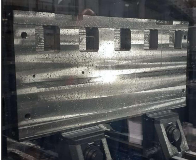
Slika 2.4. Utori kućišta nakon obrade
