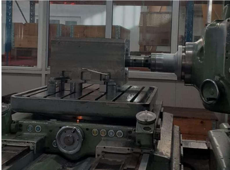
Slika 2.6. Glodanje provrta na glodalici
