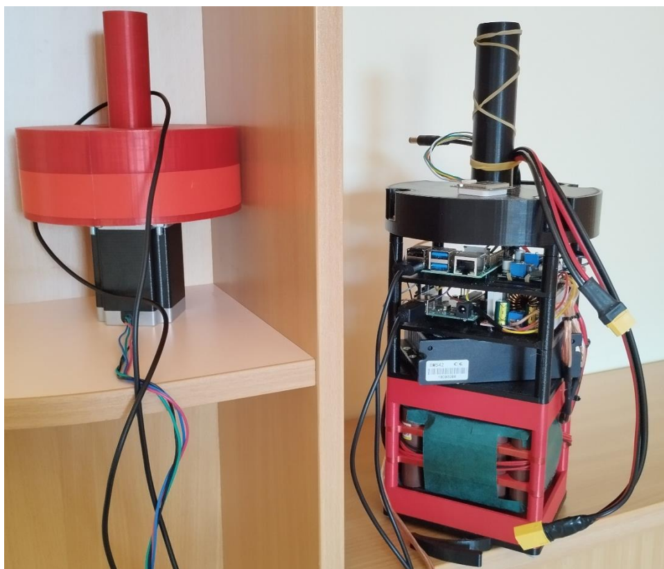
Slika 6.8 Komponente u cijevi vitla (2)
