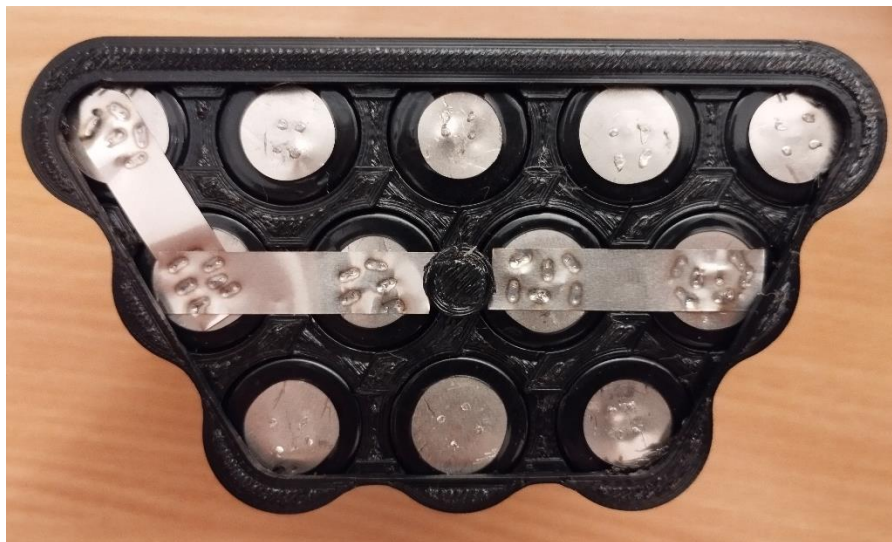
Slika 6.3 Metoda paralelnog spajanja ćelija
