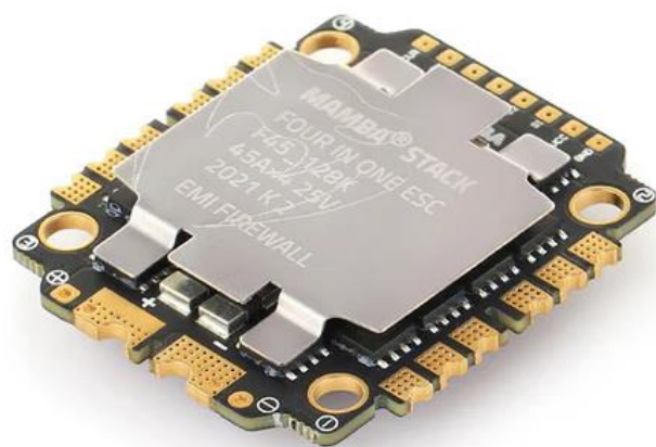
Slika 4.2 Elektronički kontroler brzine [21]
