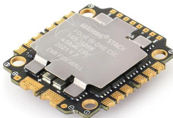
Slika 4.2 Elektronički kontroler brzine [21]
