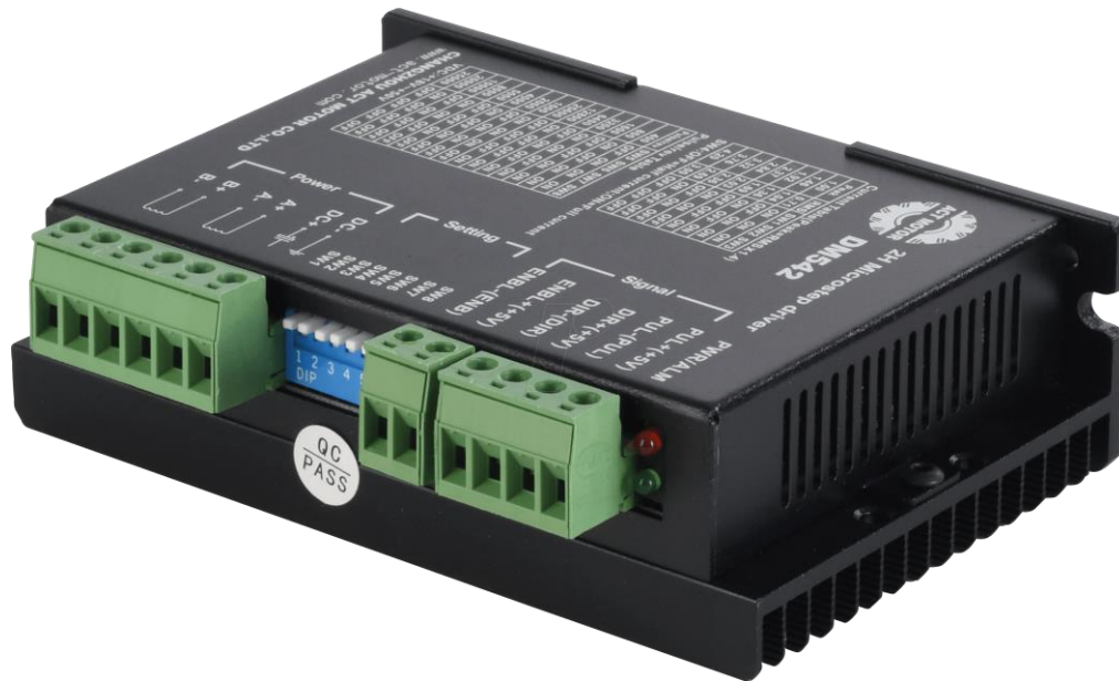
Slika 4.12 Upravljač (driver) koračnog motora DM542 [30]
