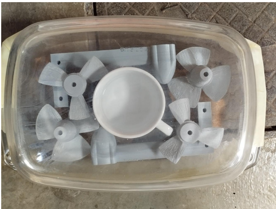
Slika 6.10 Proces zaglađivanja površine brodskih vijaka
