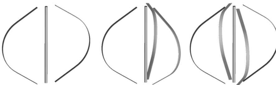
Slika 3.4. Rotor Darrieus vjetroturbine s 2, 3 i 4 lopatice [18]
