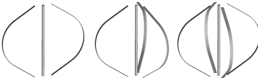
Slika 3.4. Rotor Darrieus vjetroturbine s 2, 3 i 4 lopatice [18]
