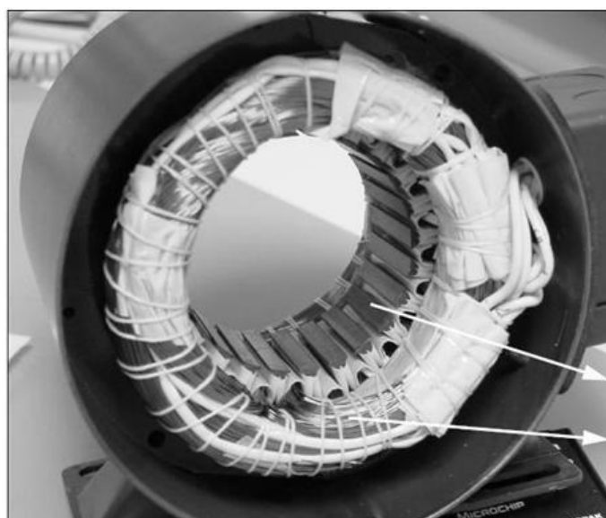
Slika 3.14 stator sinkronog motora
