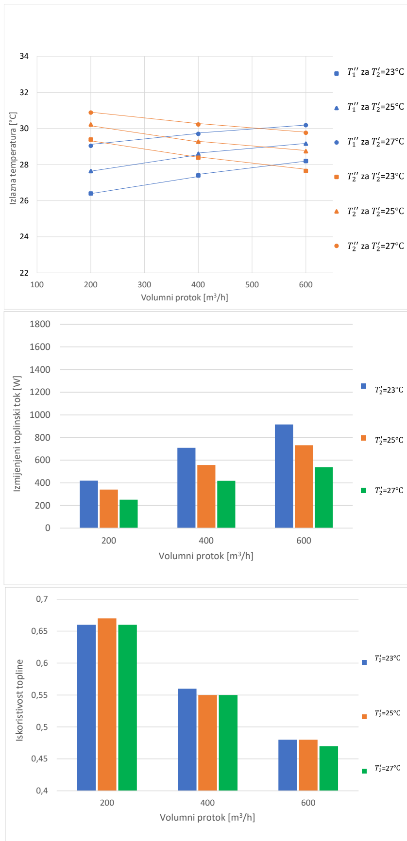
Slika 5.11: Izlazne temperature, izmijenjeni toplinski tokovi i iskoristivosti topline za ulaznu temperaturu toplog zraka 33^\circ\text{C}
