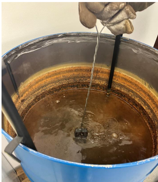
Slika 7.9 Gašenje uzorka u vodi
