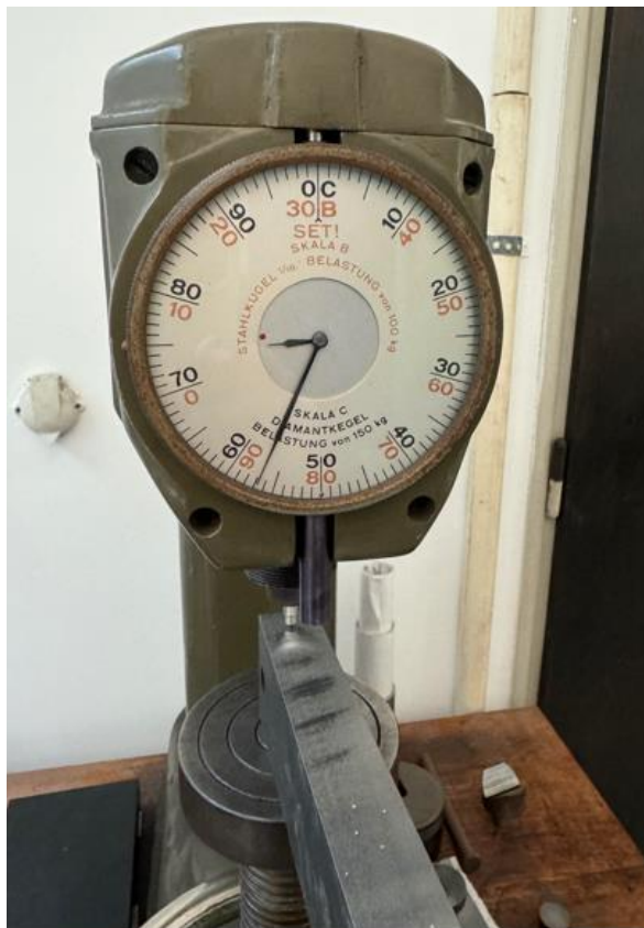
Slika 7.11 Ispitivanje tvrdoće po Rockwellu nakon kaljenja i brušenja
