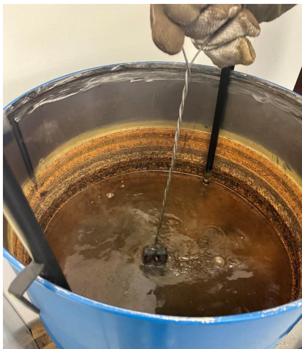
Slika 7.9 Gašenje uzorka u vodi
