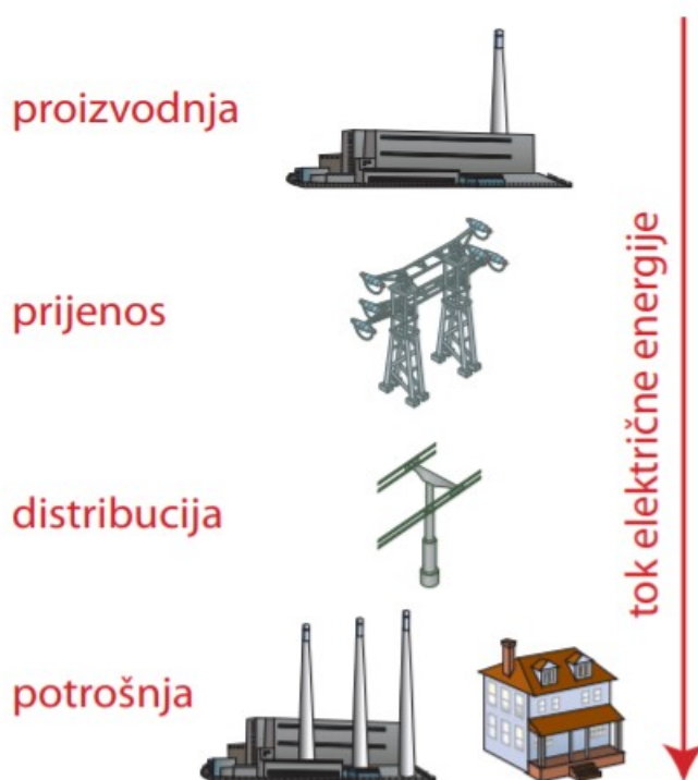
Slika 2.1. Dijelovi elektroenergetskog sustava
