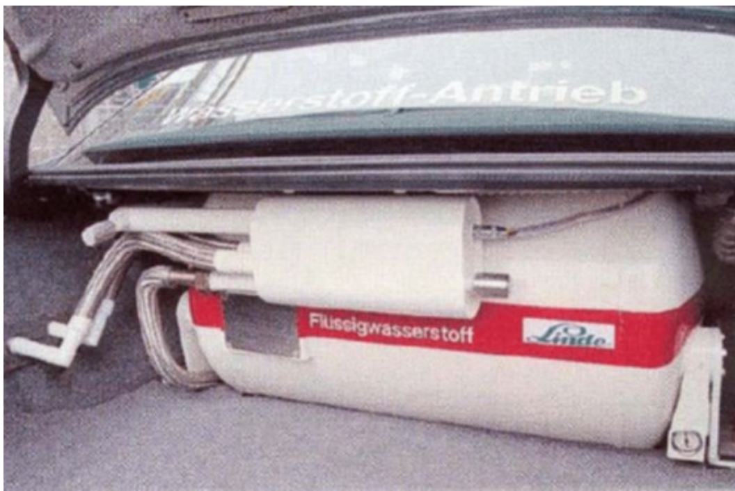
Slika 3.8 Pogled na spremnik izvana [1].
