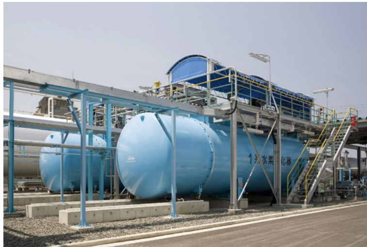
Slika 3.5 Uređaj za ukapljivanje vodika [1].
