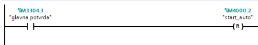
Slika 3.26. Logika za treći robot u automatskom režimu
