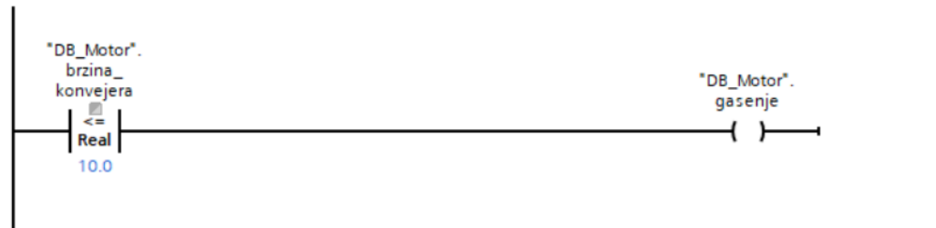
Slika 3.33. Smanjenje brzine motora konvejera
