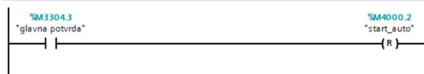
Slika 3.26. Logika za treći robot u automatskom režimu
