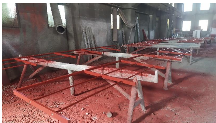
Slika 3.21. Oslanjanje elementa u komori za bojanje i sušenje
