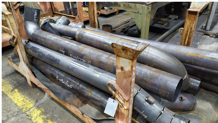
Slika 3.10. Primjer privarenih cijevi
