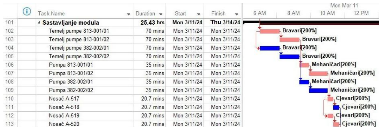
Slika 5.9. Primjer kritičnog puta u gantogramu
