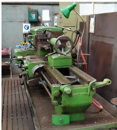
Slika 3.6. Stroj za tokarenje krajeva cijevi
