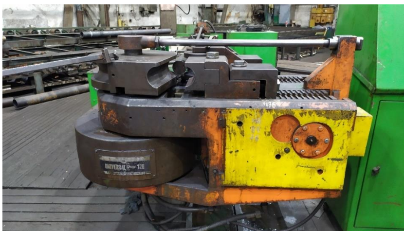
Slika 3.5. Savijačica cijevi sa unutarnjim trnom
