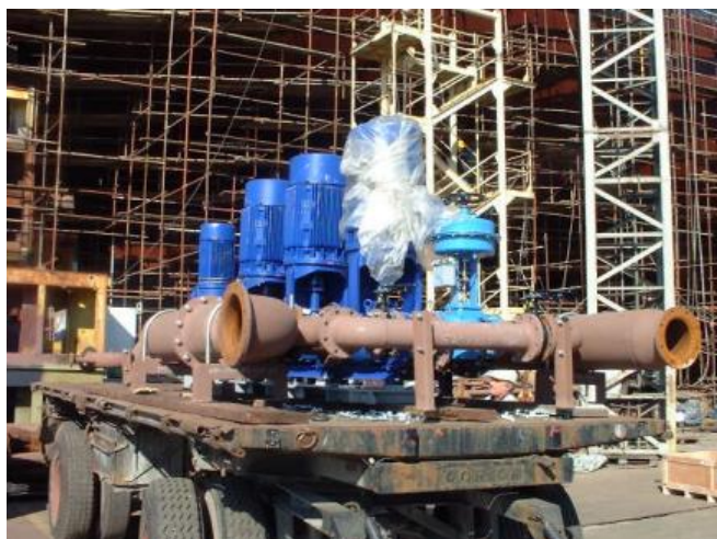
Slika 4.6. Primjer modula spremnog za ukrcaj na brod
