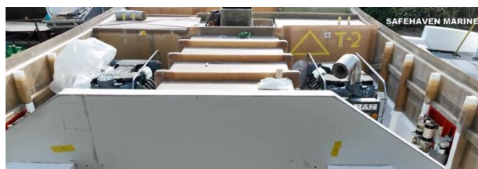
Slika 2.12. Prikaz ojačanja u strojarnici na stvarnom katamaranu [14]
