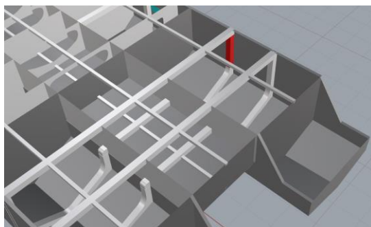
Slika 3.63. Rebro izvan područja mokre palube na računalnom modelu
