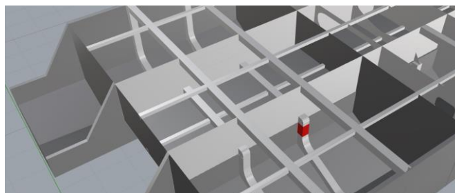
Slika 3.67. Rebro unutar područja mokre palube na računalnom modelu
