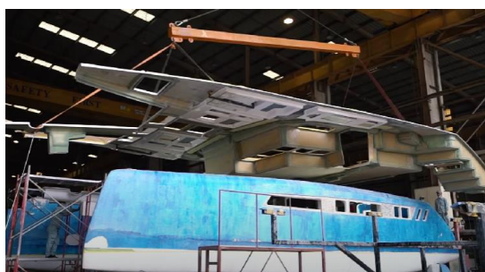
Slika 2.21. Prikaz spajanja glavne palubne i trupa u stvarnosti [15]
