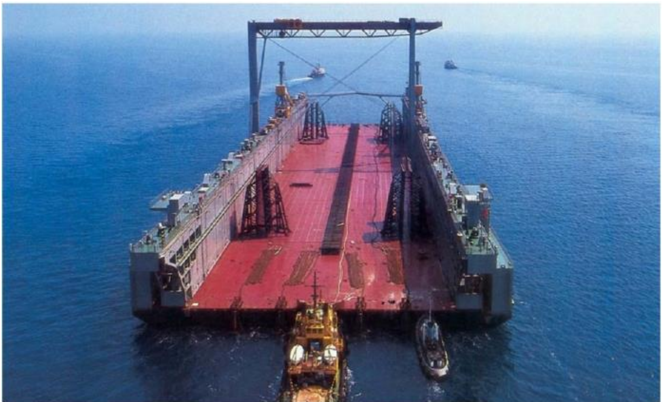
Slika 2.11. Plutajući dok za remont
