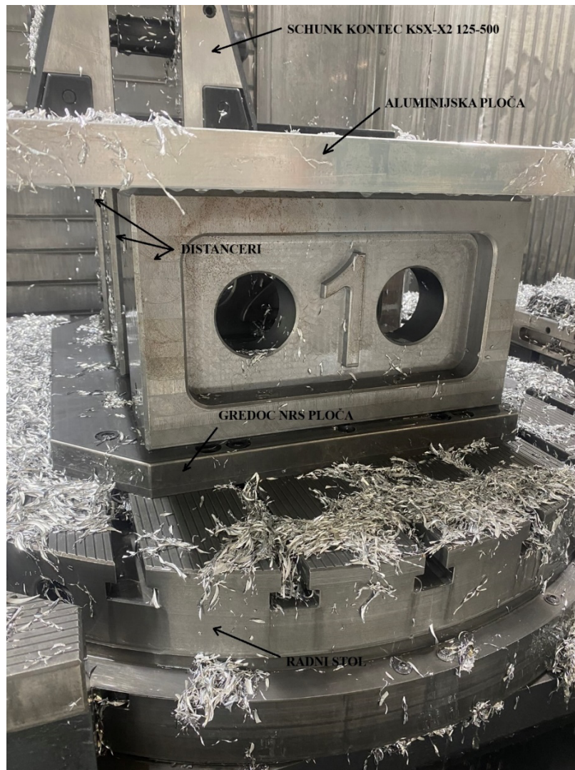
Slika 4.2.1. Stezni sustavi na radnom stolu
