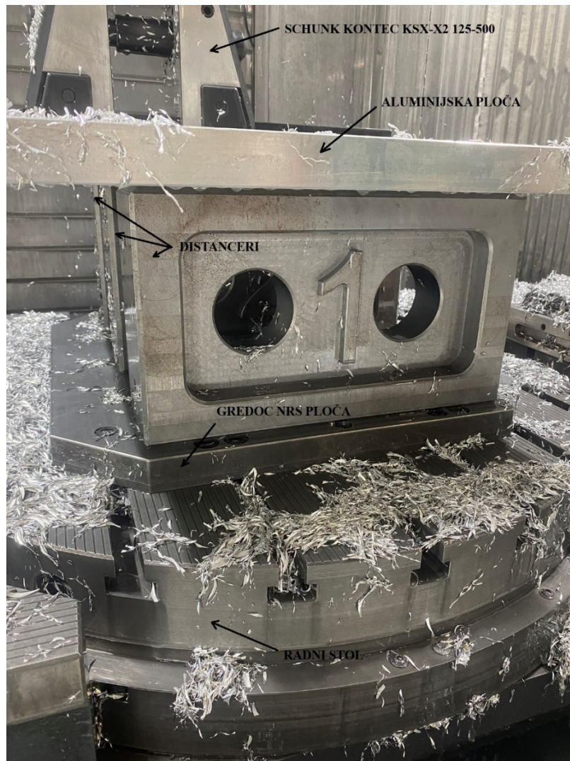
Slika 4.2.1. Stezni sustavi na radnom stolu
