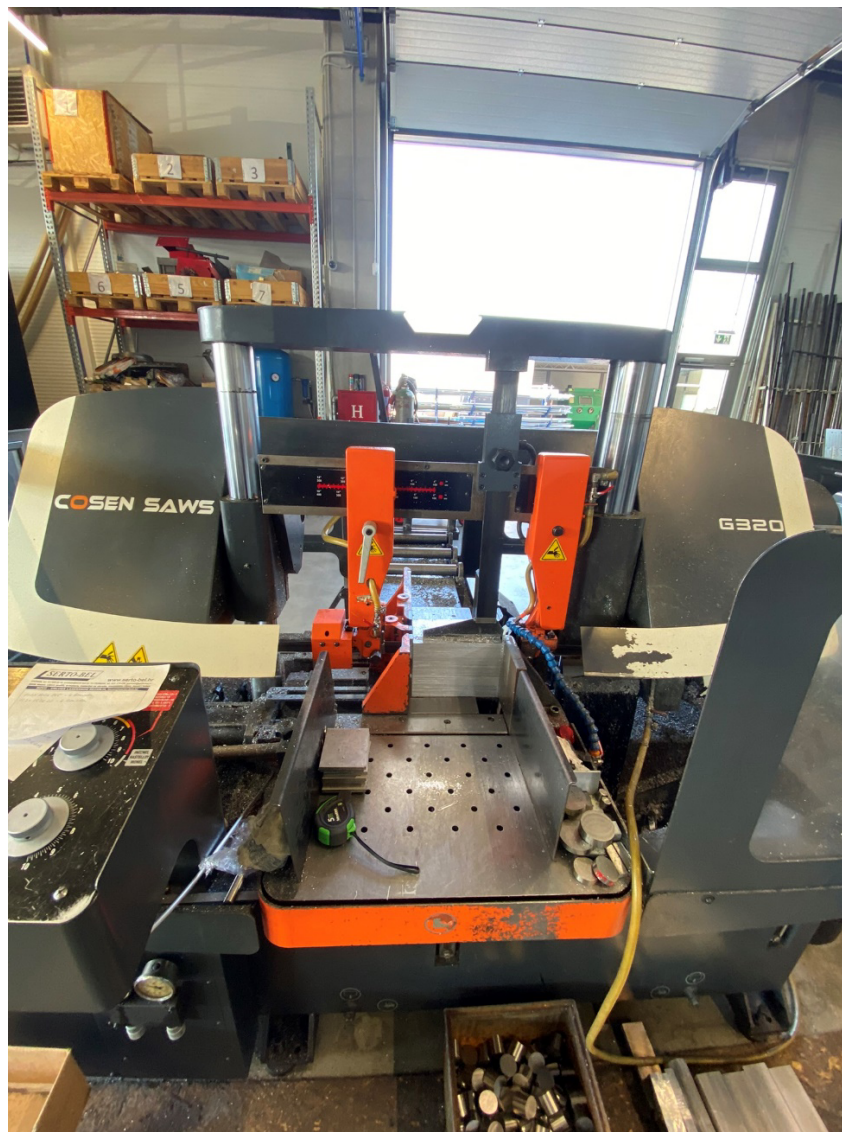
Slika 4.1.1. Rezanje sirovca Podloge na Cosen G320 pili
