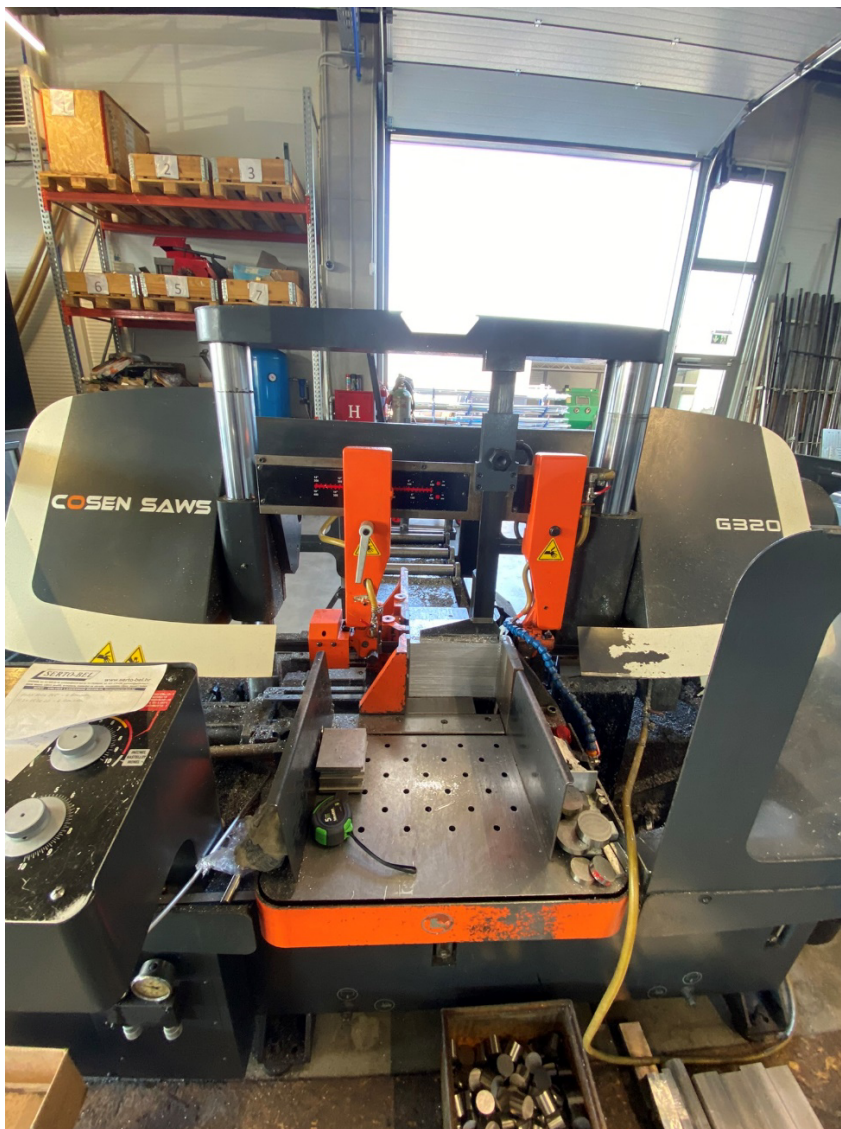
Slika 4.1.1. Rezanje sirovca Podloge na Cosen G320 pili
