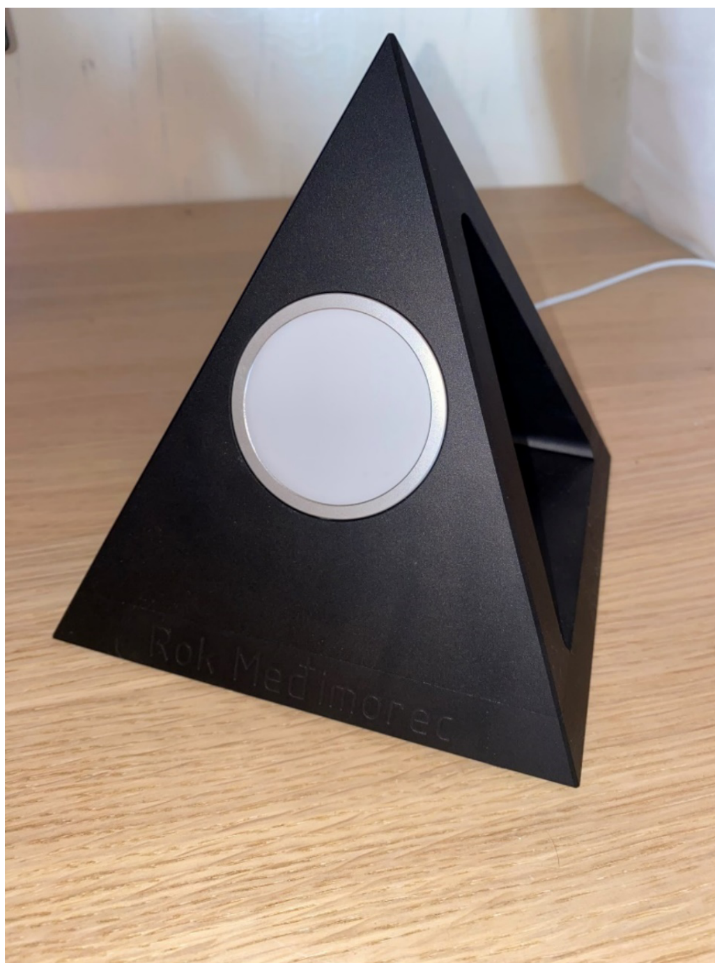
Slika 5.2.3. Sklop obratka nakon završne obrade
