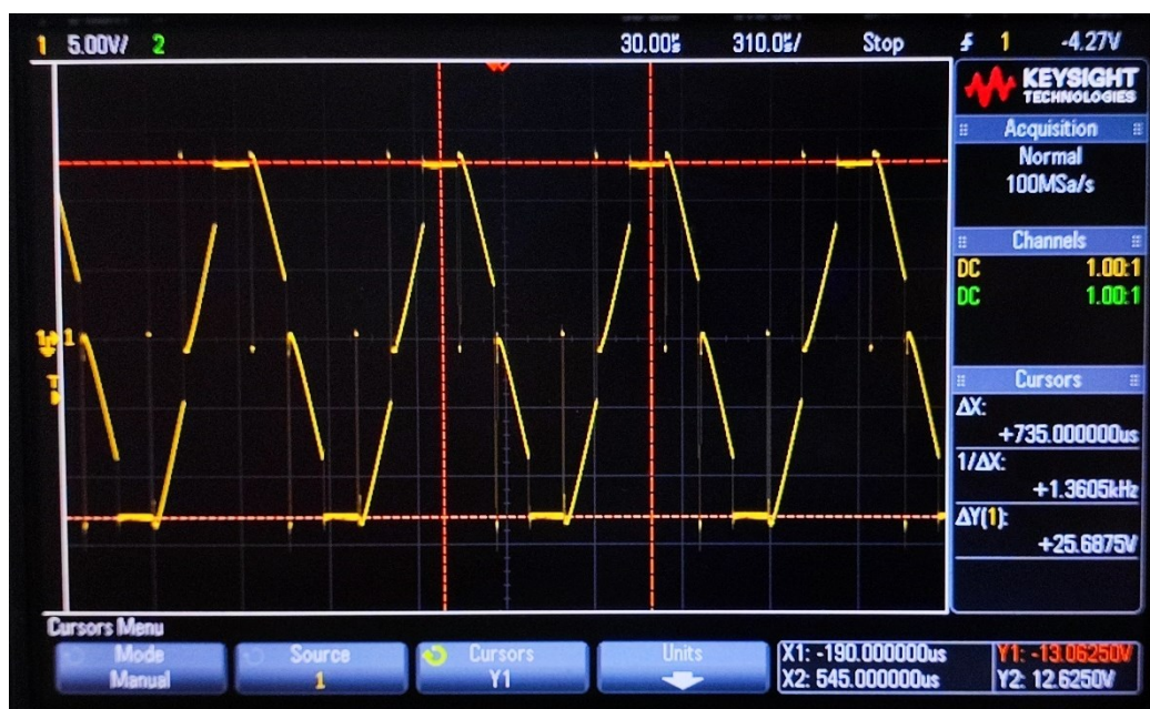
Slika 6.6. - Valni oblik izlaznog napona za veću brzinu vrtnje
