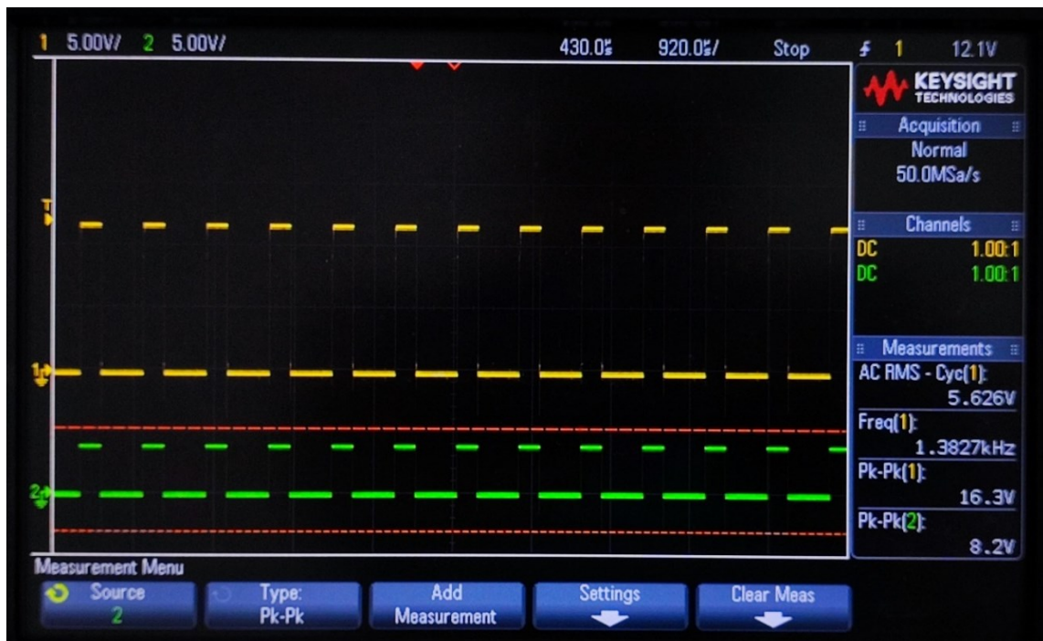
Slika 6.3. - Valni oblici upravljačkih signala za veću brzinu vrtnje
