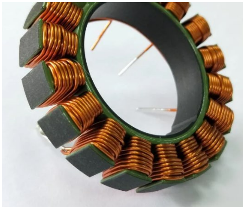
Slika 2.4. – Stator s koncentriranim namotima [4]
