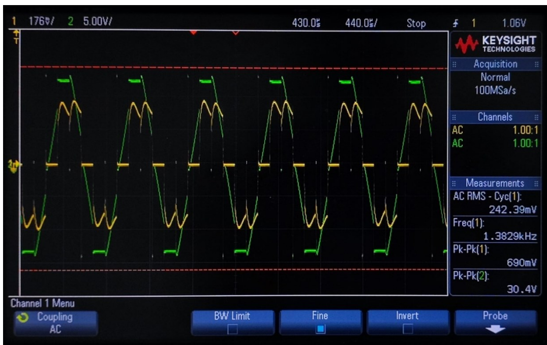
Slika 6.9. - Valni oblici struje i napona jedne faze
