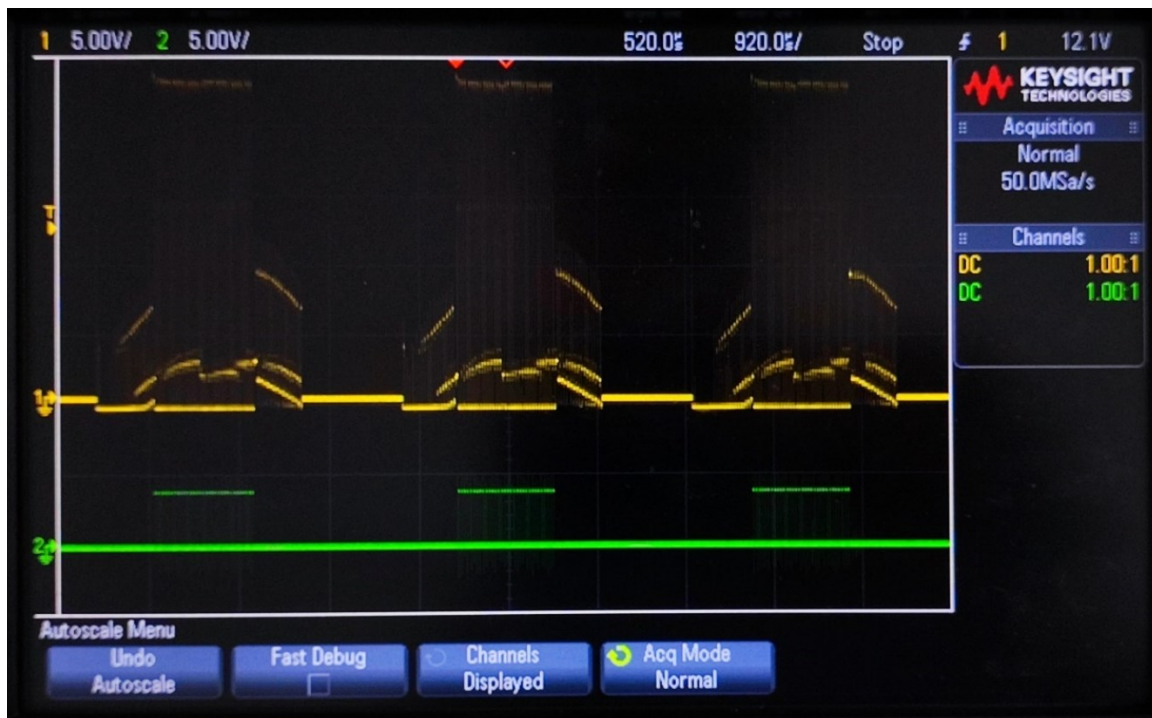
Slika 6.4. - Valni oblici upravljačkih signala high-side MOSFET-a
