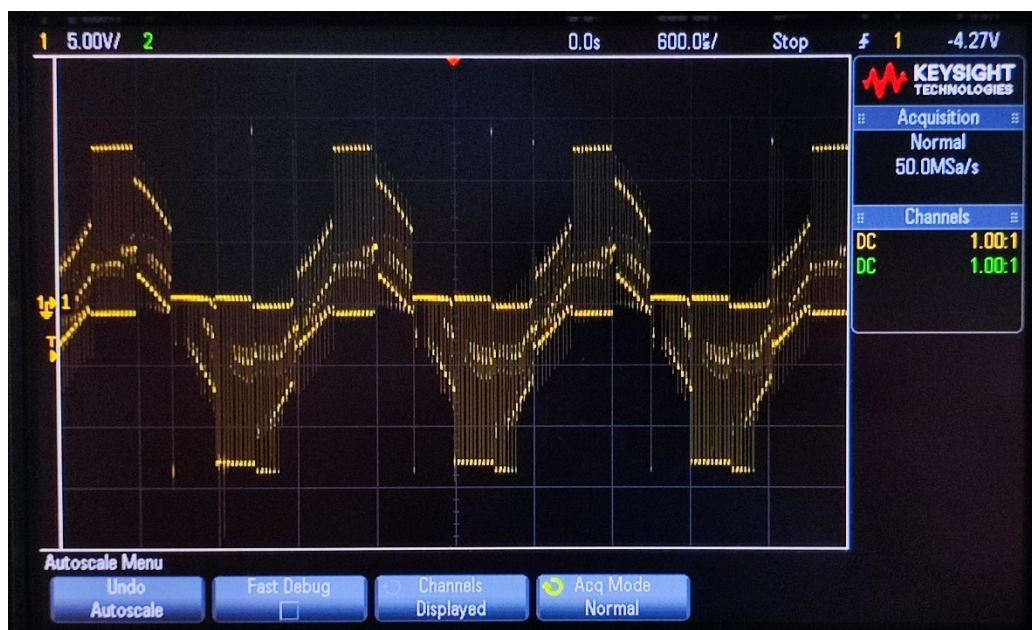
Slika 6.5. - Valni oblik izlaznog napona jedne faze
