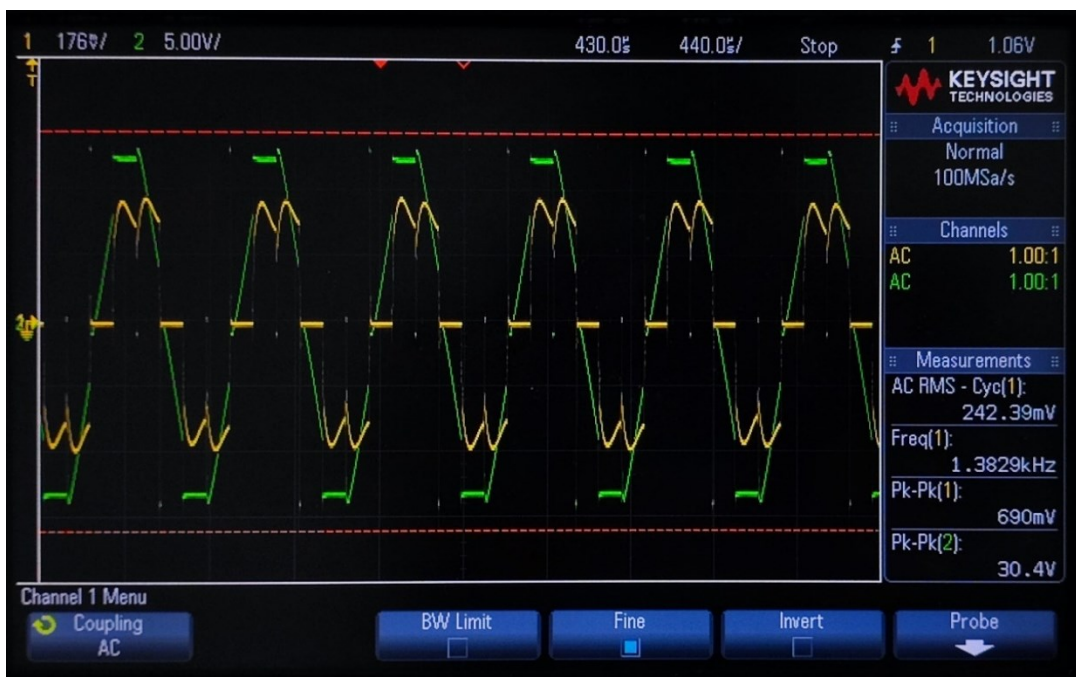
Slika 6.9. - Valni oblici struje i napona jedne faze
