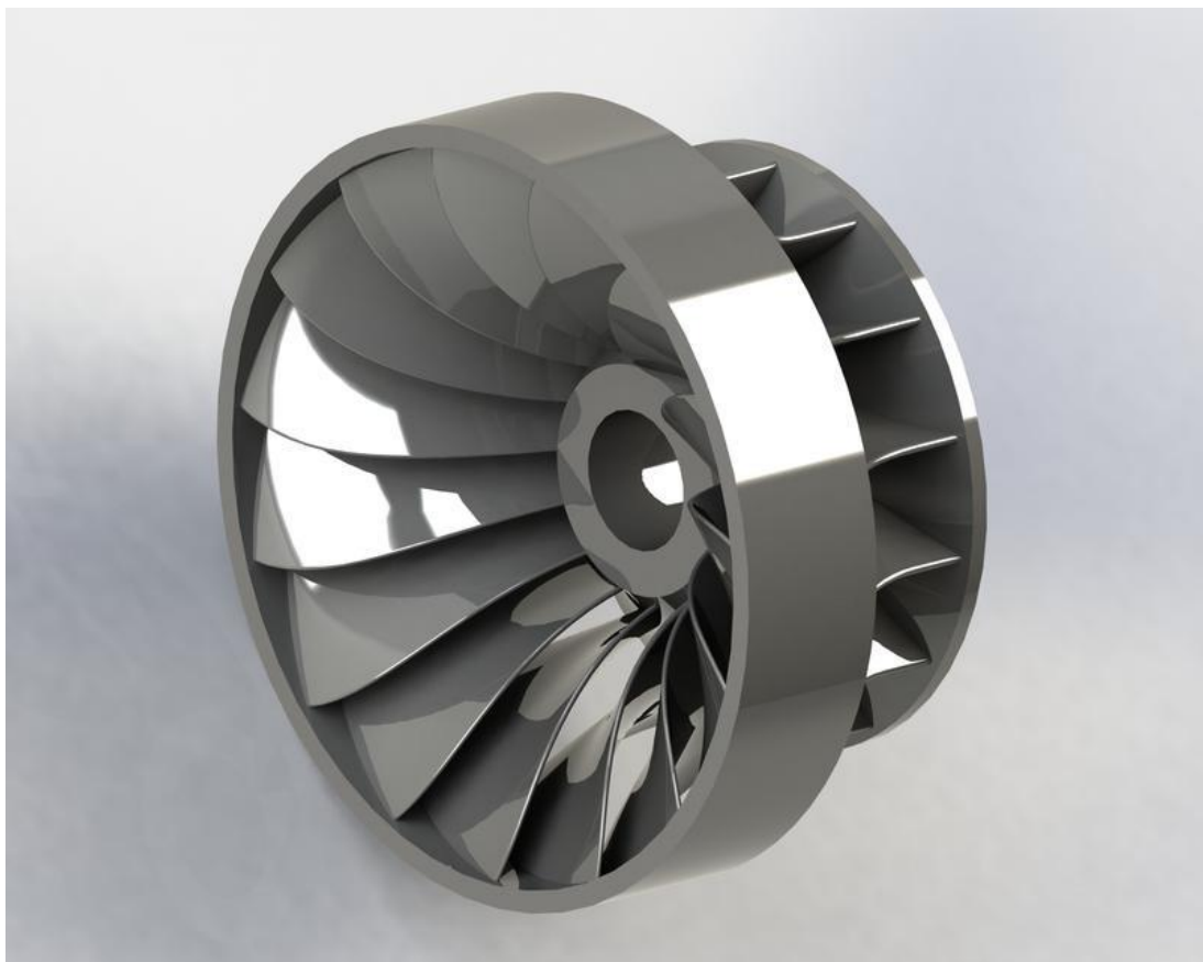
Slika 3.7 Rotor Francisove turbine [12]
