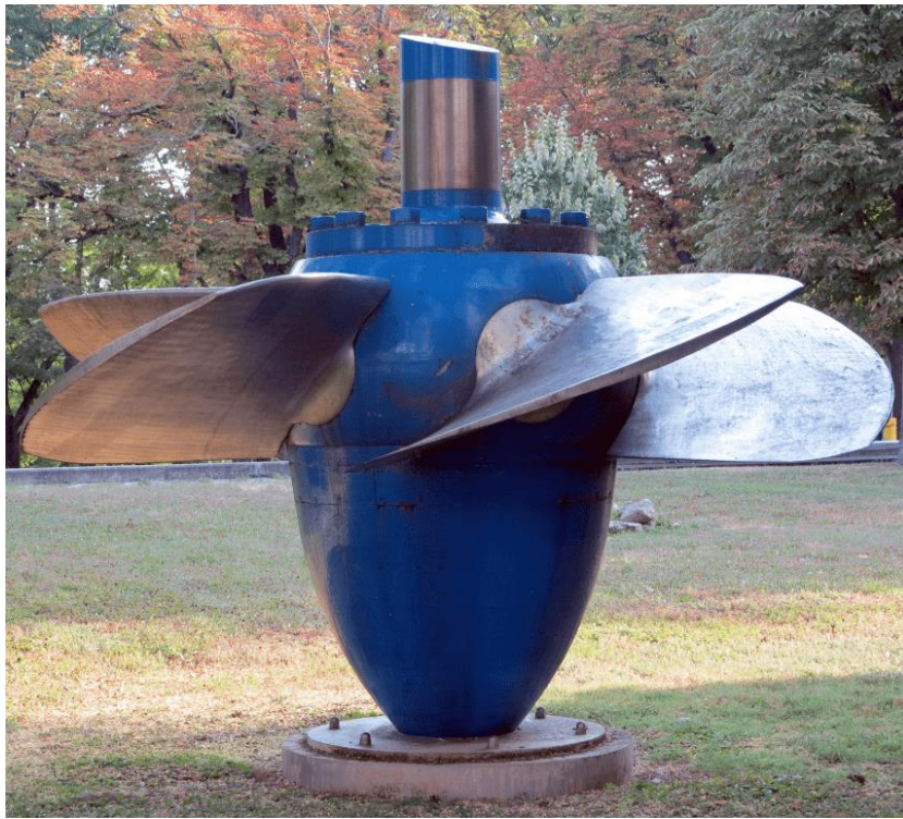
Slika 3.2 Rotor Kaplanove turbine [18]
