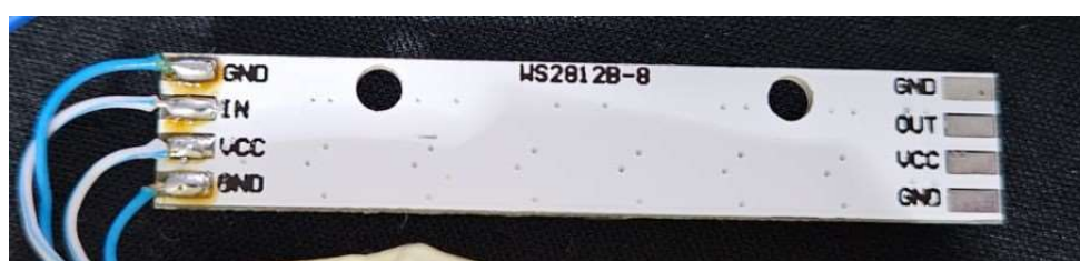
Slika 3.7. Prikaz WS2812B-8 modula sa stražnje strane.
