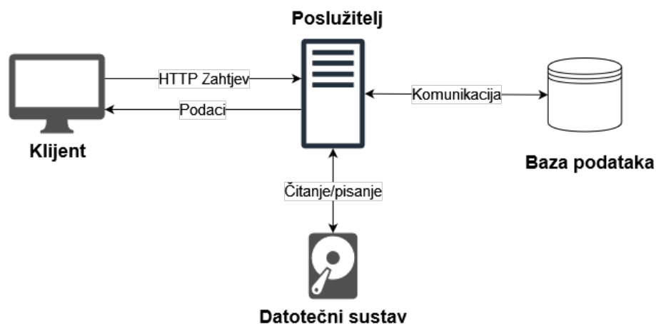
Slika 3.1 Dijagram arhitekture sustava
