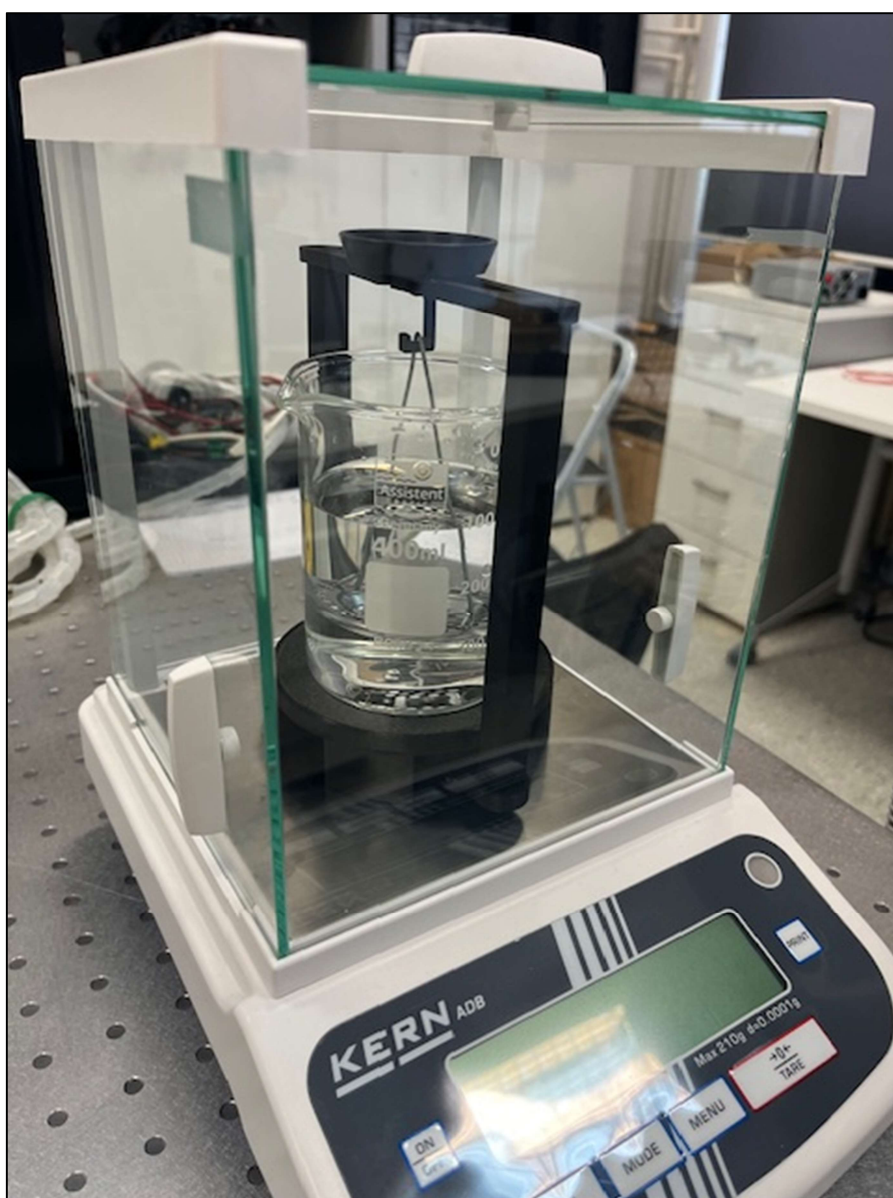
Slika 4.3 Konačan izgled prihvata montiranog na vazi
