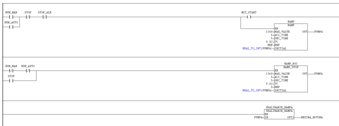
Slika 5.8. Upravljanje blokom rampe
