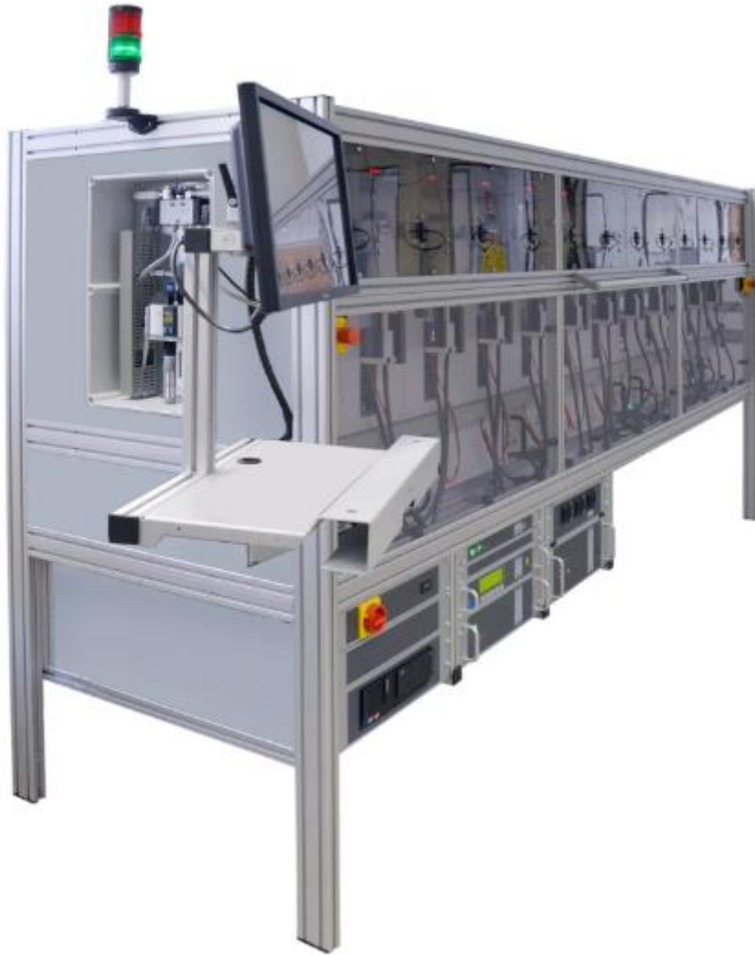
Slika 5.2.1 GFUVE profesionalni sustav za umjeravanje dvadeset brojila [16.]
