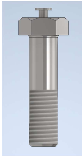
Slika 2.5. Vijak M12 sa svornjakom M4
