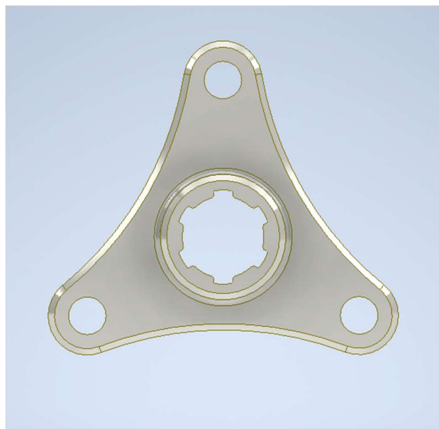
Slika 2.3. Model glavine centrifugalne spojke s papučama
