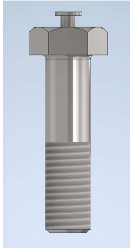
Slika 2.5. Vijak M12 sa svornjakom M4
