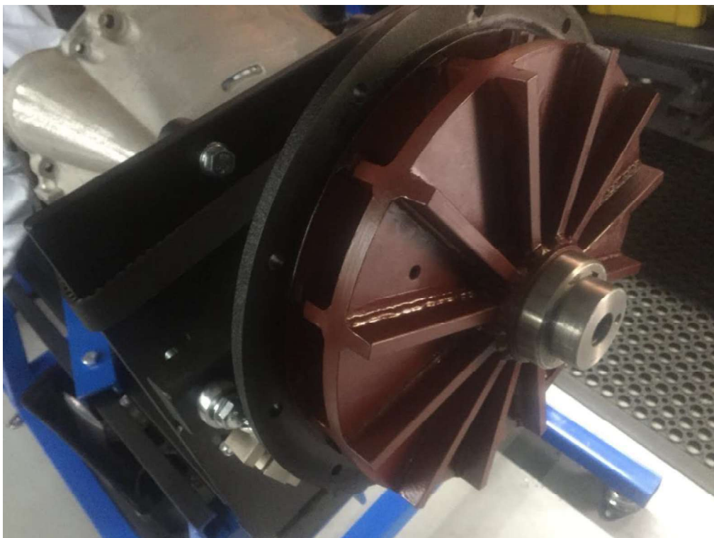
Slika 3.3. Primjer jednostavne hidraulične kočnice s uklonjenim kućištem [3]
