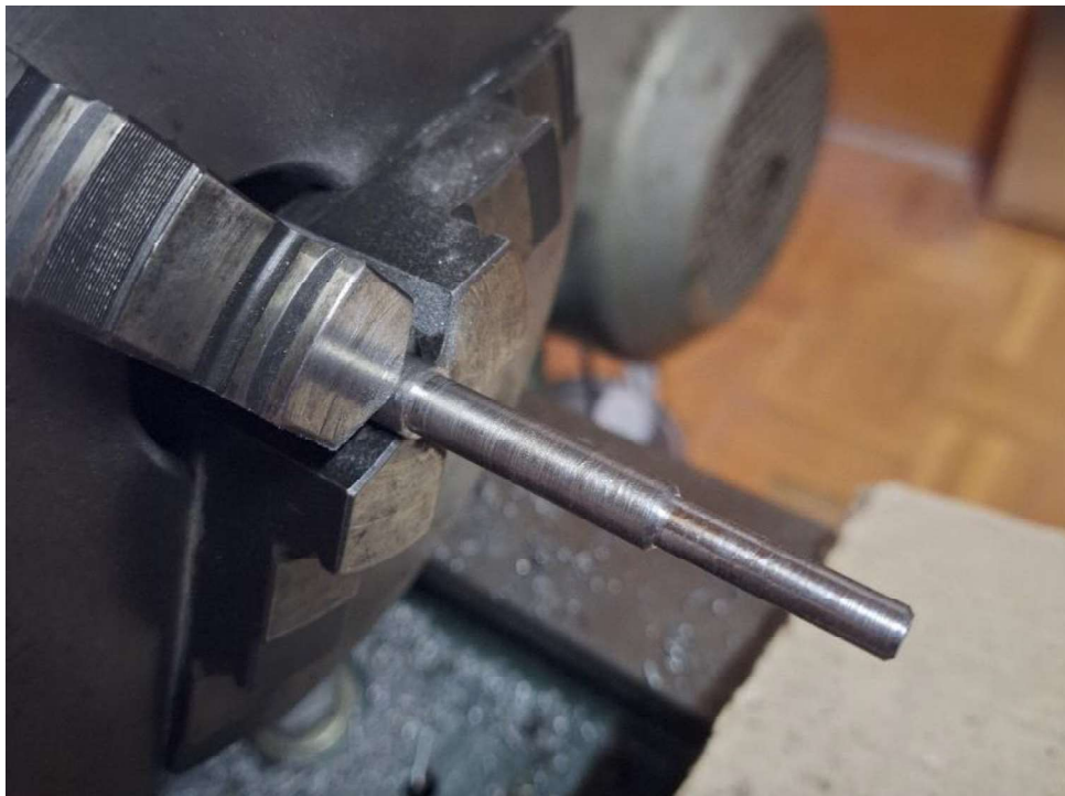
Slika 4.7. Vratilo u steznoj glavi tokarilice
