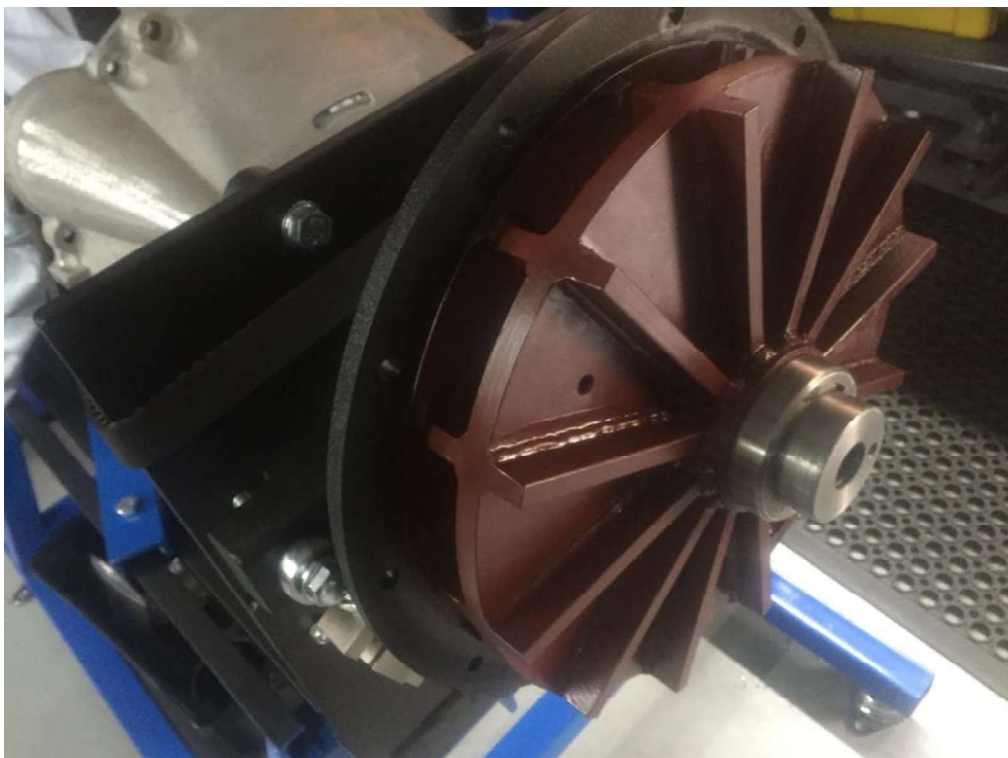
Slika 3.3. Primjer jednostavne hidraulične kočnice s uklonjenim kućištem [3]
