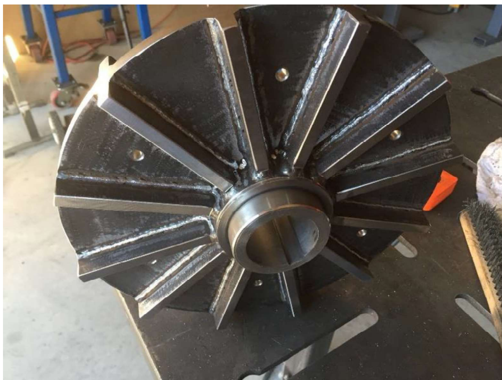
Slika 3.1. Primjer rotora jednostavne hidraulične kočnice [3]
