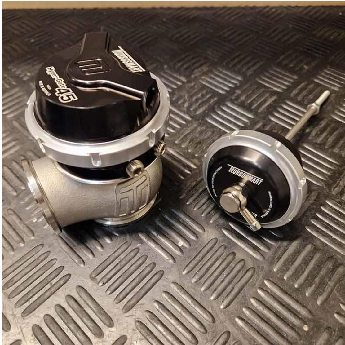
Slika 2.3. Unutarnji (lijevo) i vanjski(desno) wastegate ventil
