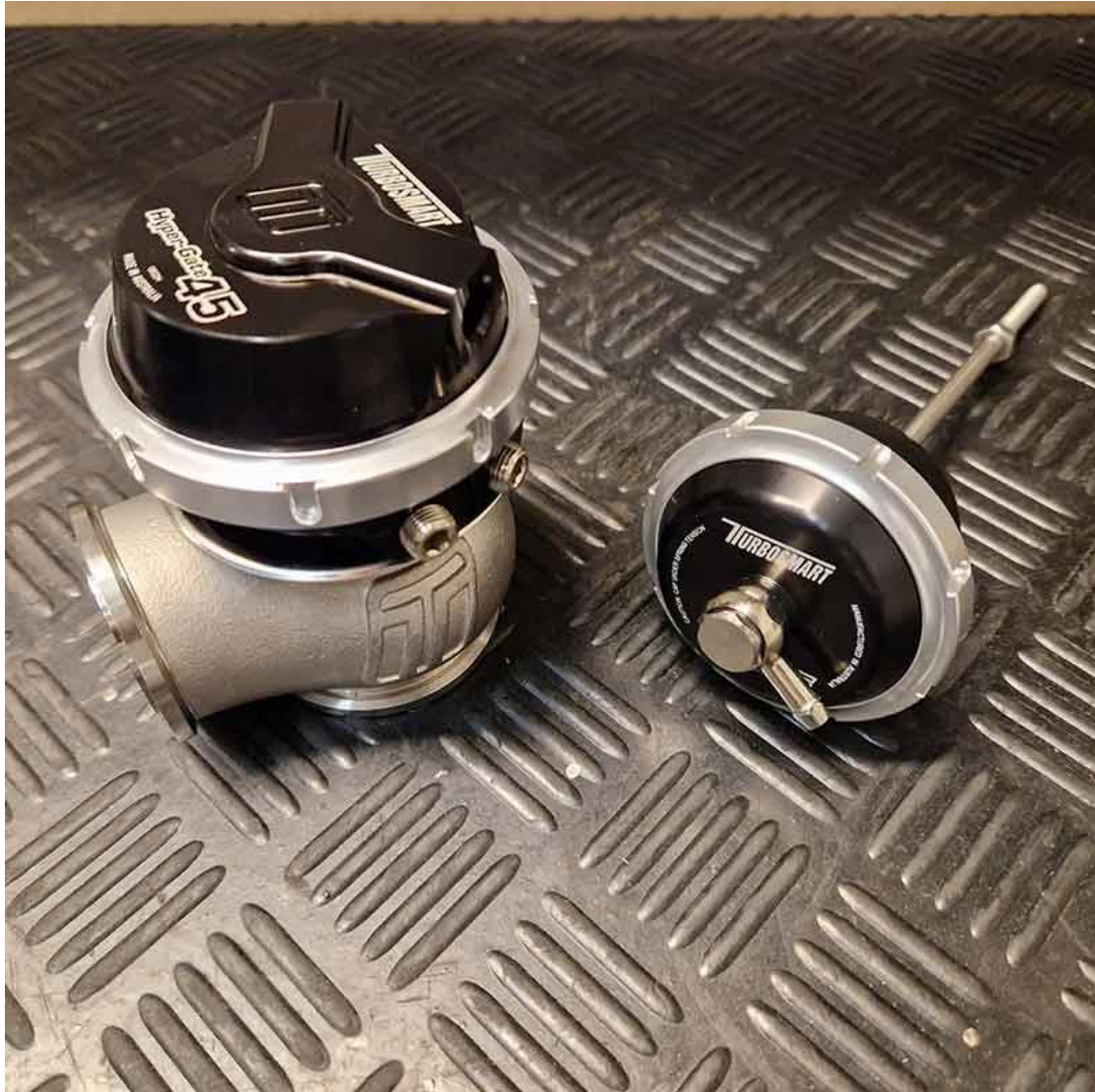
Slika 2.3. Unutarnji (lijevo) i vanjski(desno) wastegate ventil
