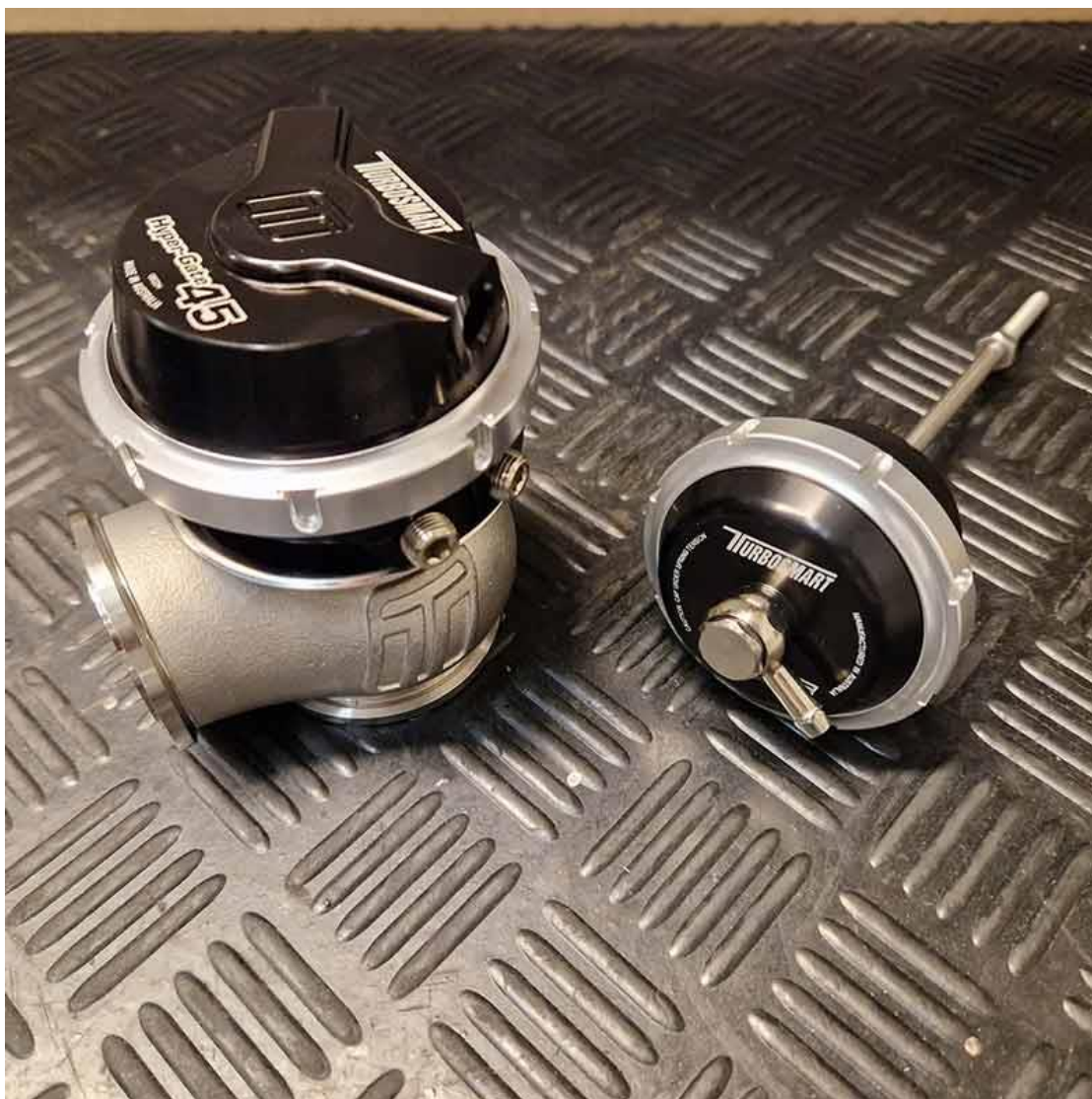
Slika 2.3. Unutarnji (lijevo) i vanjski(desno) wastegate ventil
