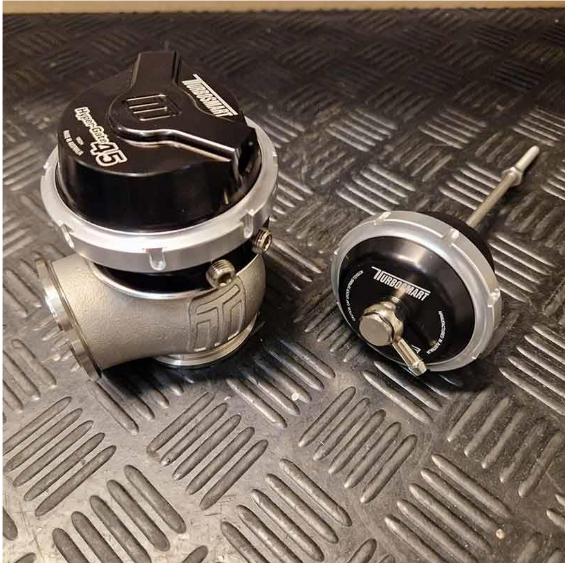
Slika 2.3. Unutarnji (lijevo) i vanjski(desno) wastegate ventil
