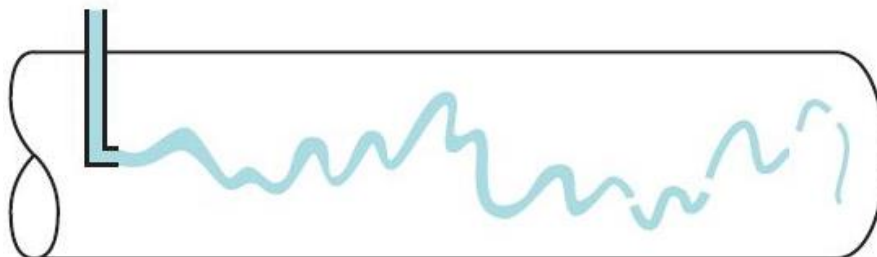
Slika 4.4. Ilustracija turbulentnog strujanja [10]
