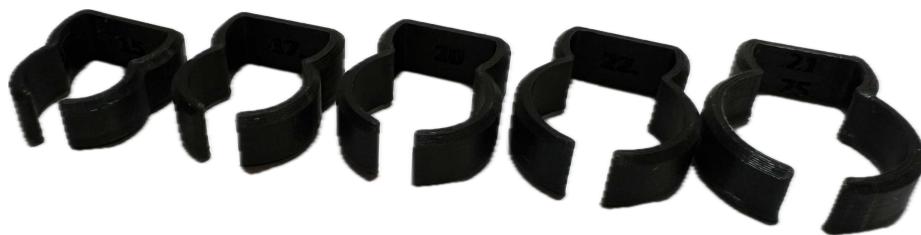
Slika 5.10. Isprintani modeli prstenja za prihvat - s lijeva na desno promjera od 15 mm do 25 mm u koracima od 2,5 mm.
