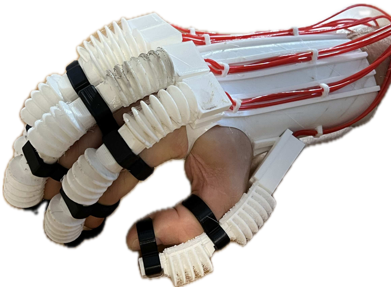
Slika 5.21. Savijeno stanje svih segmenata mekih robota rukavice tijekom korištenja.
