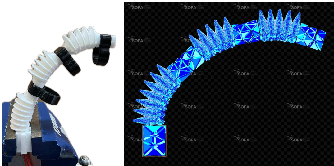
Slika 5.20. Usporedba savijenog stanja isprintanog modela mekog robota sa stanjem dobivenim simulacijom pri tlaku od 8 bar.
