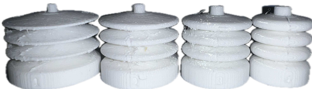
Slika 5.5. Isprintani modeli segmenata za test debljine stijenke - s lijeva na desno debljine stijenke od 0,4 mm do 1,6 mm u koracima od 0,4 mm.
