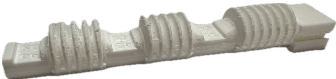
Slika 5.8. Isprintani model mekog robota.
