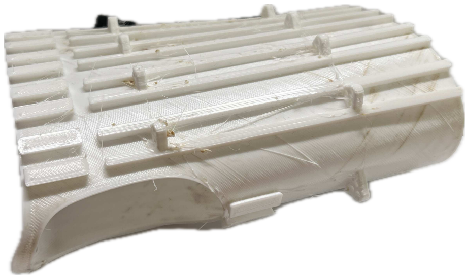
Slika 5.13. Isprintani model rukavice za prihvata mekih robota.
