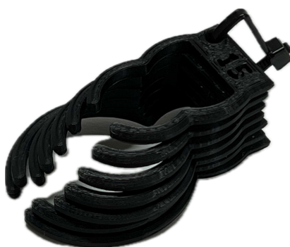
Slika 5.12. Isprintani modeli mjernih prstenja.
