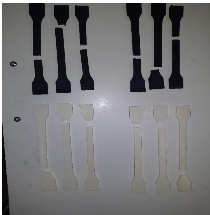
Slika 4.10. Prikaz serija PLA i ABS uzoraka nakon loma
