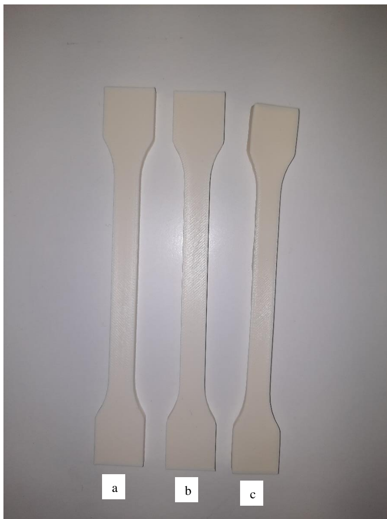
Slika 4.6. Jedna serija ABS uzoraka s (a) termički neobrađenom epruvetom, (b) epruvetom grijanom na 60 °C i (c) epruvetom grijanom na 100 °
