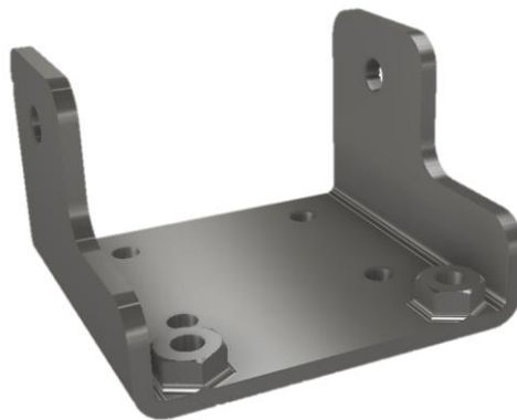
Slika 3.9 Geometrijski model elementa "Šarka 1" – engll. perspective view
