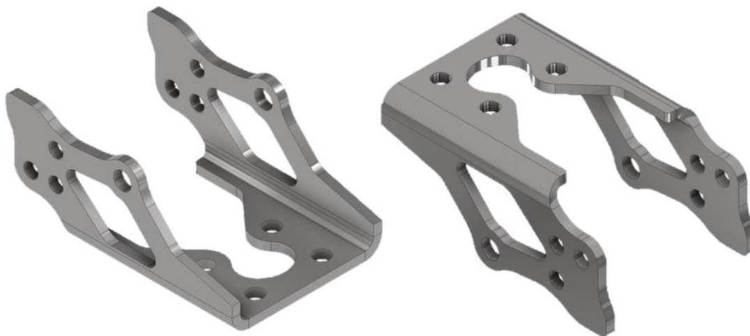
Slika 9.6 Optimizirani geometrijski model elementa „Šarka 2“ („Sheet Metal“)
