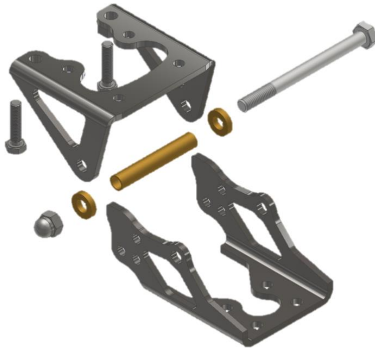
Slika 9.8 Krajnje rješenje optimiziranog sklopa šarke – raščlanjeni prikaz
