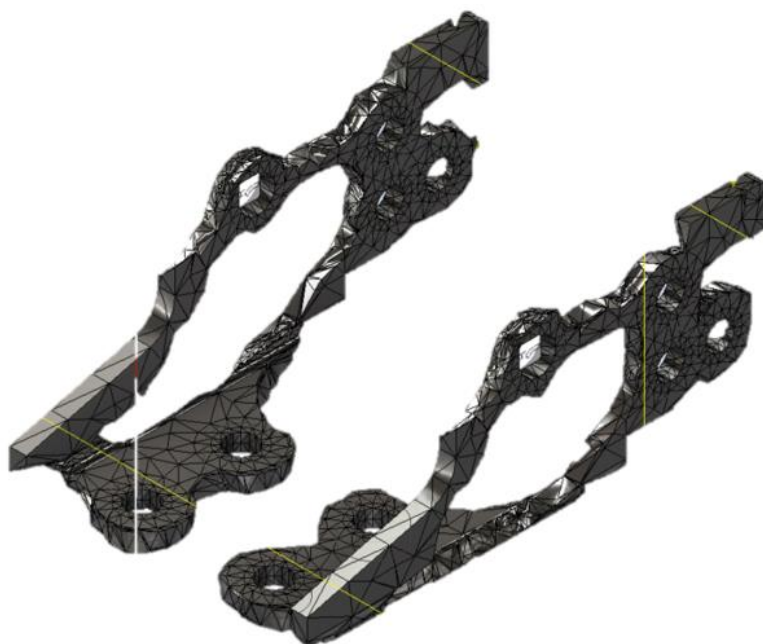
Slika 7.32 Rezultat optimizacije topologije elementa „Šarka 2“ (60% reducirana masa)
