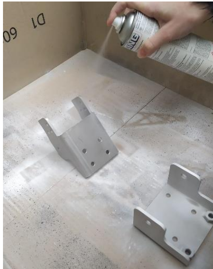
Slika 2.5 Nanošenje tankog sloja bijelog praha (priprema predmeta za skeniranje)
