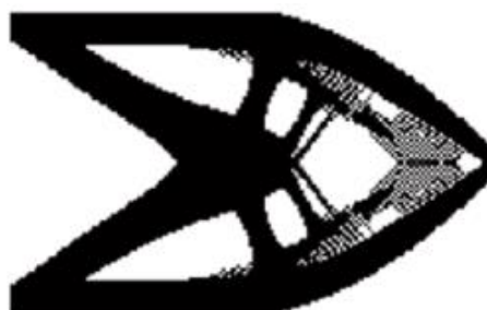
Slika 6.5 Pojava „šahovnice“ unutar dgeneriranog dizajna [6]
