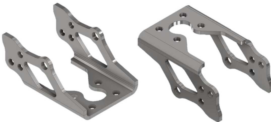
Slika 9.6 Optimizirani geometrijski model elementa „Šarka 2“ („Sheet Metal“)
