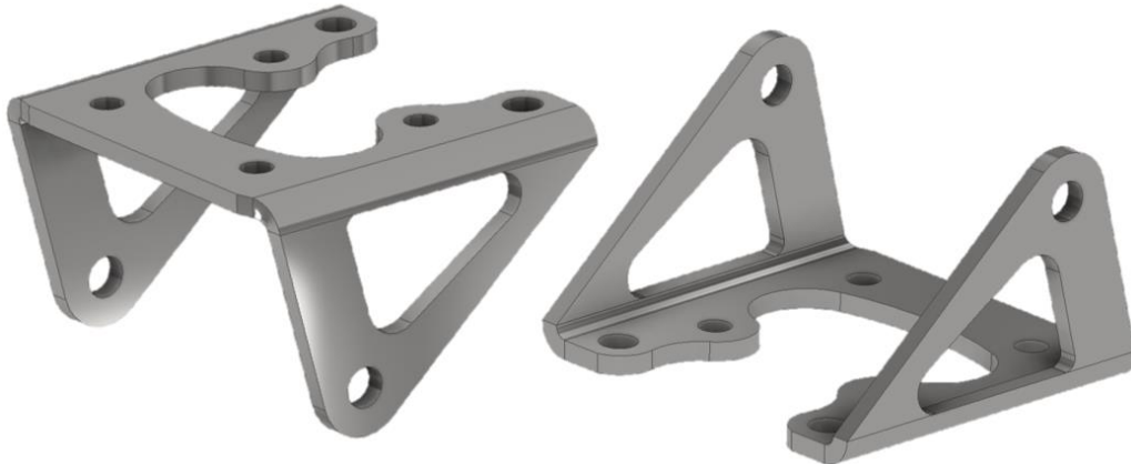
Slika 9.4 Optimizirani geometrijski model elementa „Šarka 1“ („Sheet Metal“)
