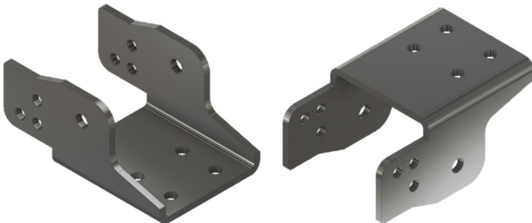
Slika 7.23 Geometrijski model „Šarka 2“ za potrebe optimizacije topologije
