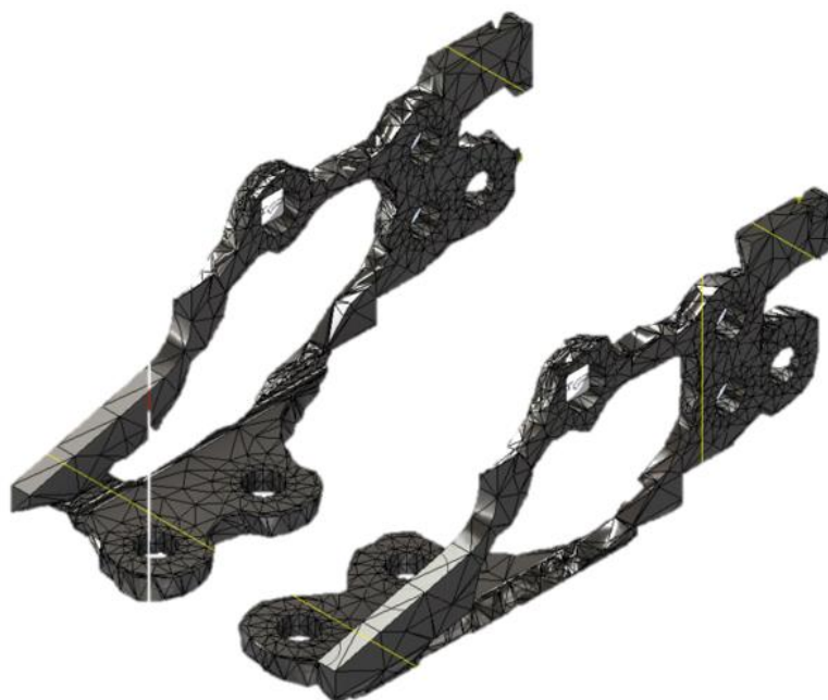
Slika 7.32 Rezultat optimizacije topologije elementa „Šarka 2“ (60% reducirana masa)
