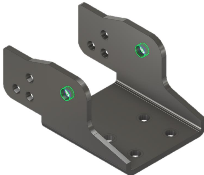
Slika 7.24 Aplikirani oslonci na element „Šarka 2“ (optimizacija topologije)
