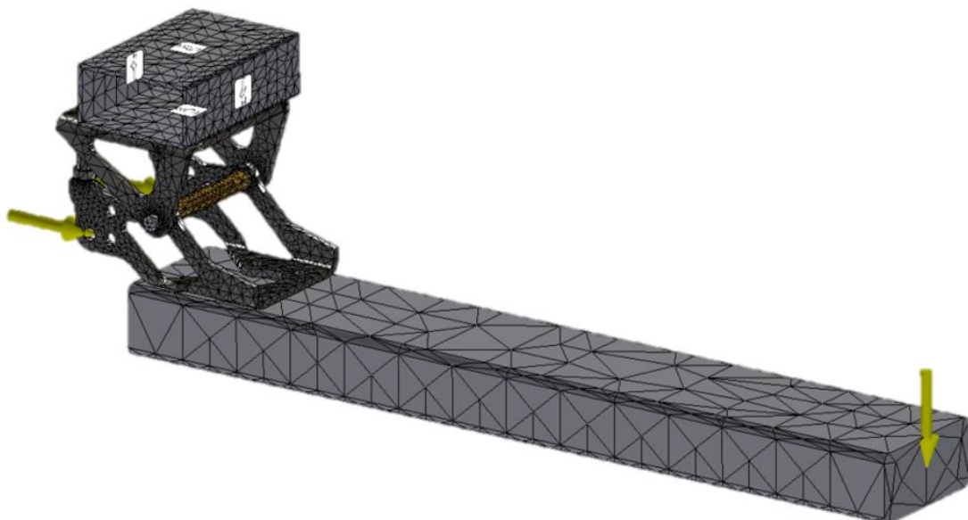
Slika 8.3 Naredba "Local Mesh Control"
