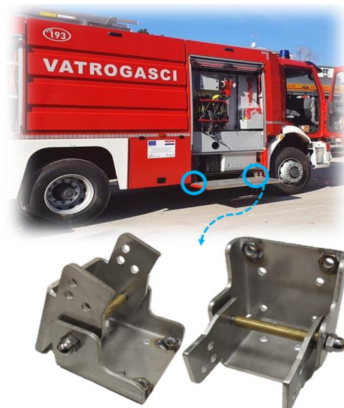
Slika 1.1 Položaj promatranih šarki na specijalnom vozilu
