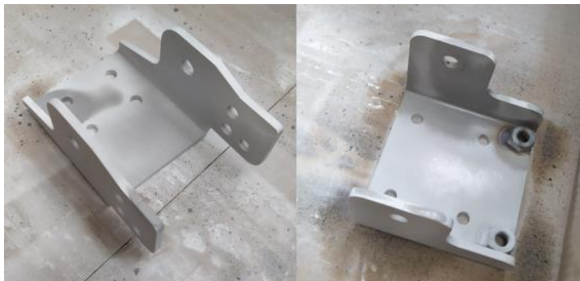
Slika 2.7 Elementi "Šarka 1" i "Šarka 2" - pripremljeni za skeniranje
