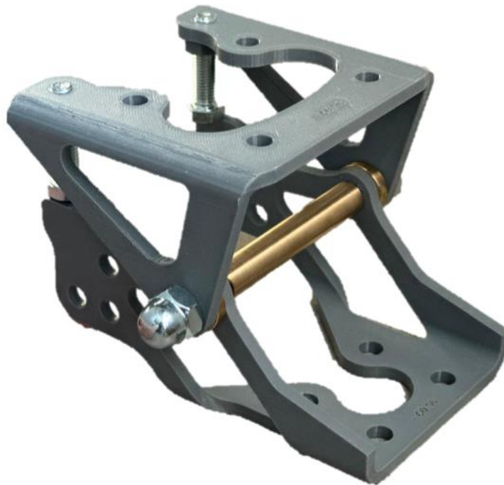
Slika 10.6 Izrađeni pokazni primjer – optimizirani geometrijski model sklopa šarke sa 60% reduciranom masom
