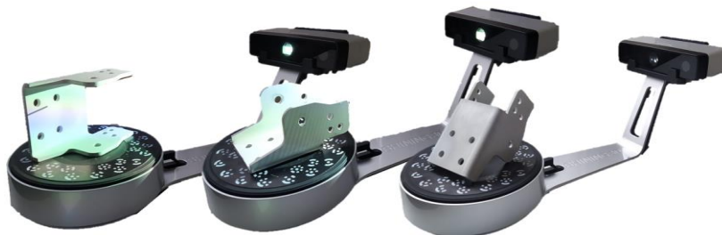
Slika 2.10 Položaji elementa "Šarka 2" prilikom skeniranja
