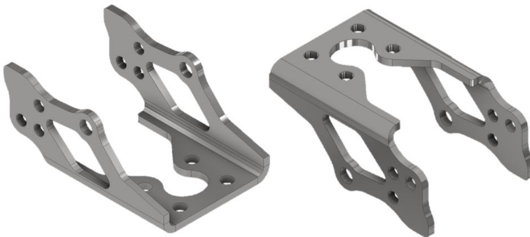
Slika 9.6 Optimizirani geometrijski model elementa „Šarka 2“ („Sheet Metal“)
