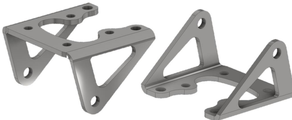
Slika 9.4 Optimizirani geometrijski model elementa „Šarka 1“ („Sheet Metal“)
