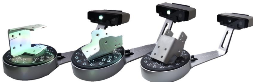
Slika 2.10 Položaji elementa "Šarka 2" prilikom skeniranja
