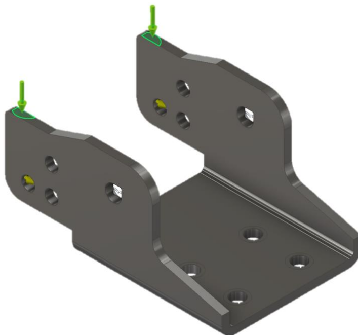
Slika 7.26 Aplikirane sile F_1 i F_{pa} na element „Šarka 2“ (optimizacija topologije)
