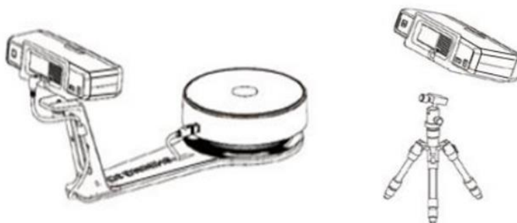
Slika 2.2 Opcije skeniranja s okretnim stolom (lijevo) i bez okretnog stola (desno) [2]
