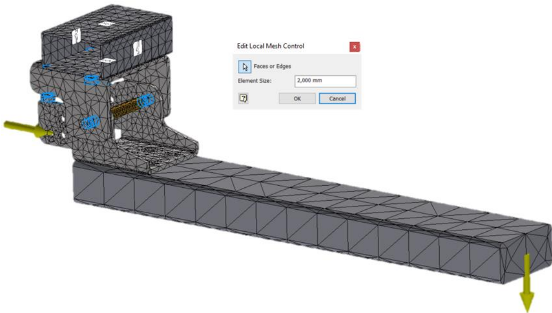
Slika 4.14 Naredba "engl. Local Mesh Control"
