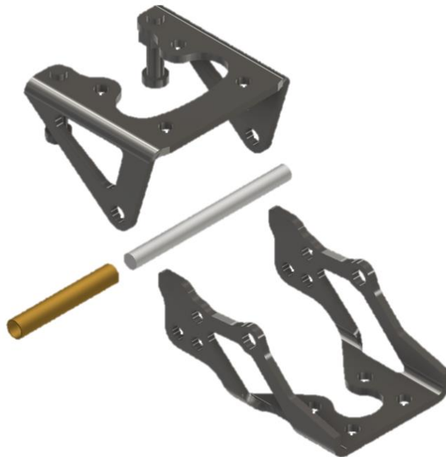
Slika 7.39 Optimizirani geometrijski model sklopa šarke – raščlanjeni prikaz (60% reducirana masa)
