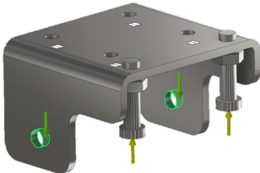
Slika 7.11 Aplicirane sile na element „Šarka 1“ (optimizacija topologije)
