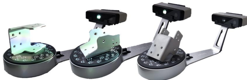
Slika 2.10 Položaji elementa "Šarka 2" prilikom skeniranja
