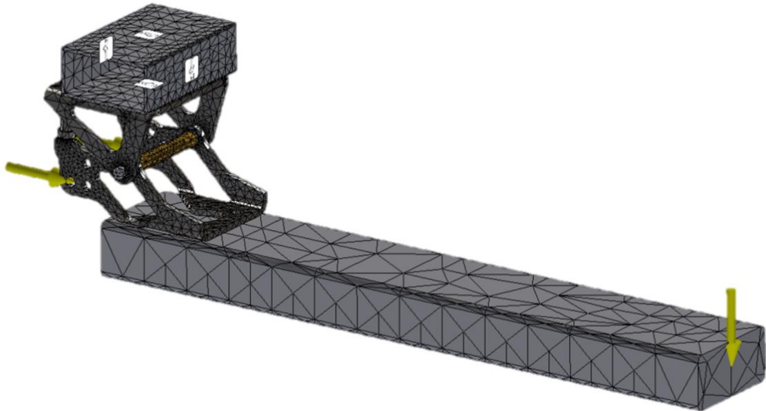
Slika 8.2 Početni omreženi model optimiziranog modela sklopa šarke
