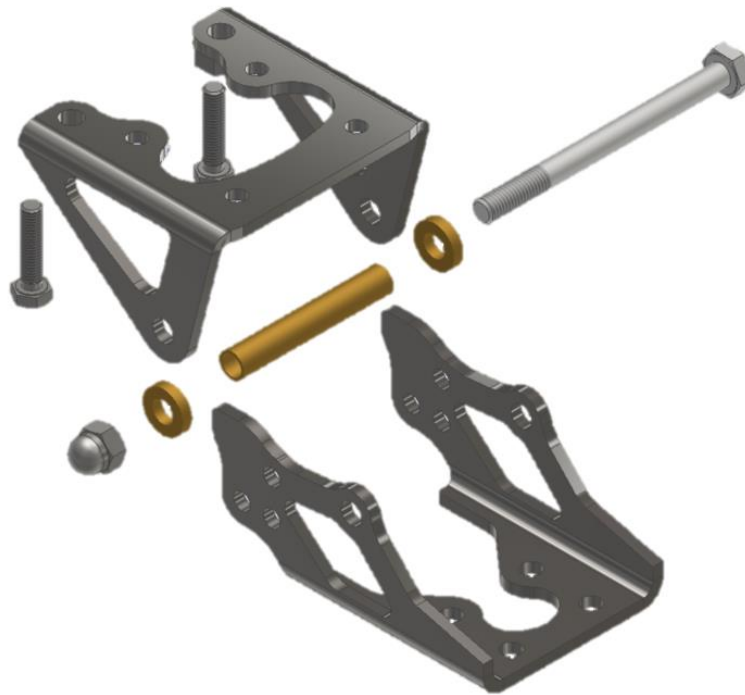
Slika 9.8 Krajnje rješenje optimiziranog sklopa šarke – raščlanjeni prikaz
