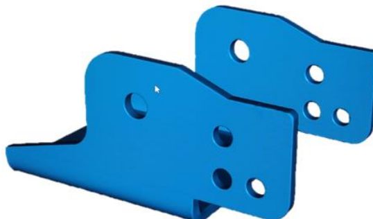
Slika 2.11 Rezultat skeniranja (sken) elementa "Šarka 2"
