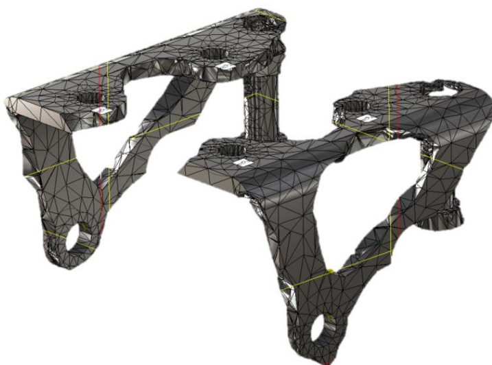
Slika 7.19 Rezultat optimizacije topologije elementa „Šarka 1“ (reduciranjem mase 60%)
