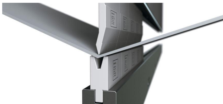
Slika 9.2 Postupak savijanja limova [14]
