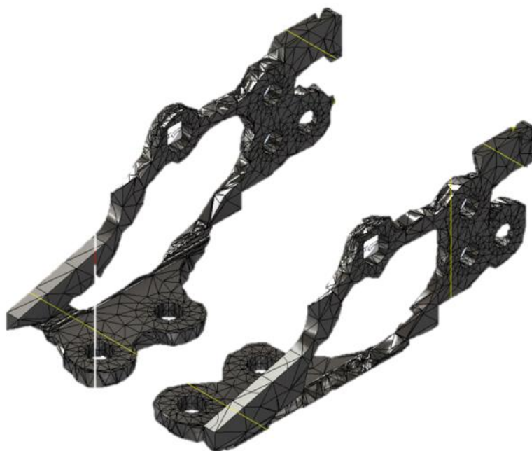
Slika 7.32 Rezultat optimizacije topologije elementa „Šarka 2“ (60% reducirana masa)
