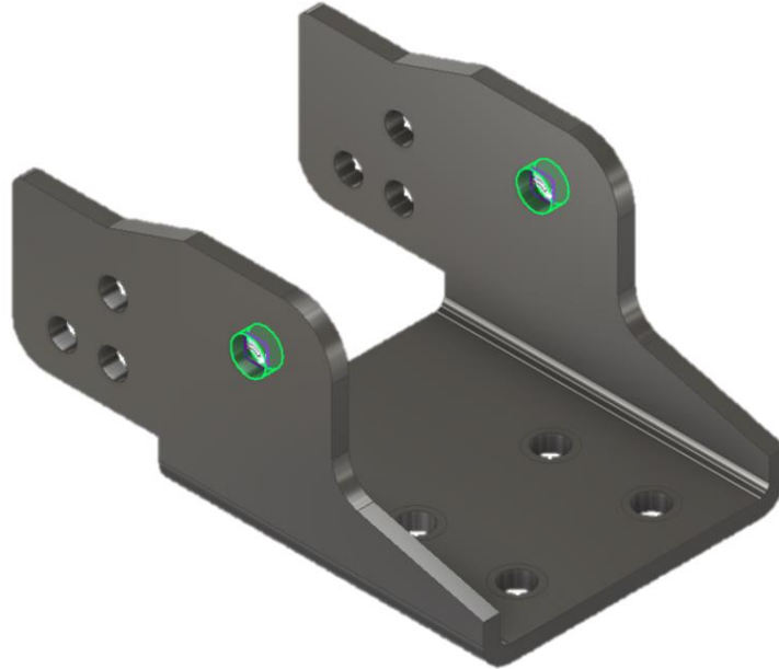
Slika 7.24 Aplikirani oslonci na element „Šarka 2“ (optimizacija topologije)
