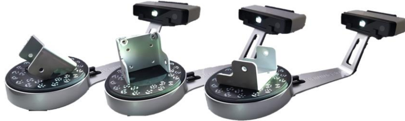
Slika 2.8 Položaji elementa "Šarka 1" prilikom skeniranja
