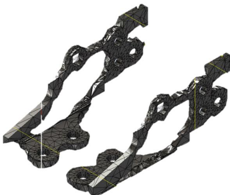
Slika 7.32 Rezultat optimizacije topologije elementa „Šarka 2“ (60% reducirana masa)
