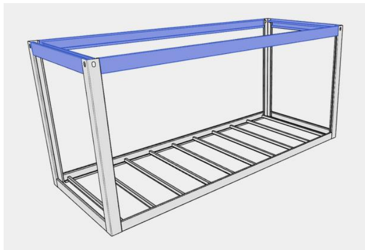
Slika 2.3. Pozicije krovnih profila
