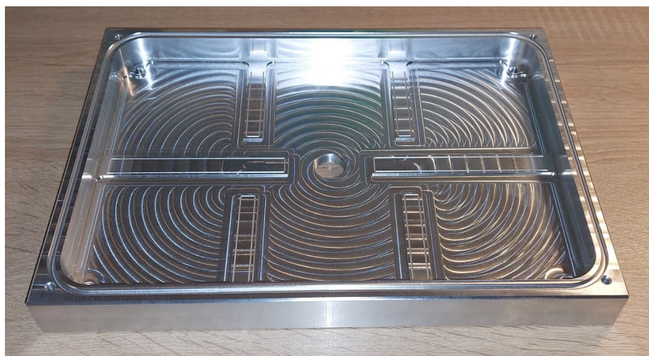
Slika 7.1.7. Finalni prikaz donjeg dijela naprave – Pozicija 1
