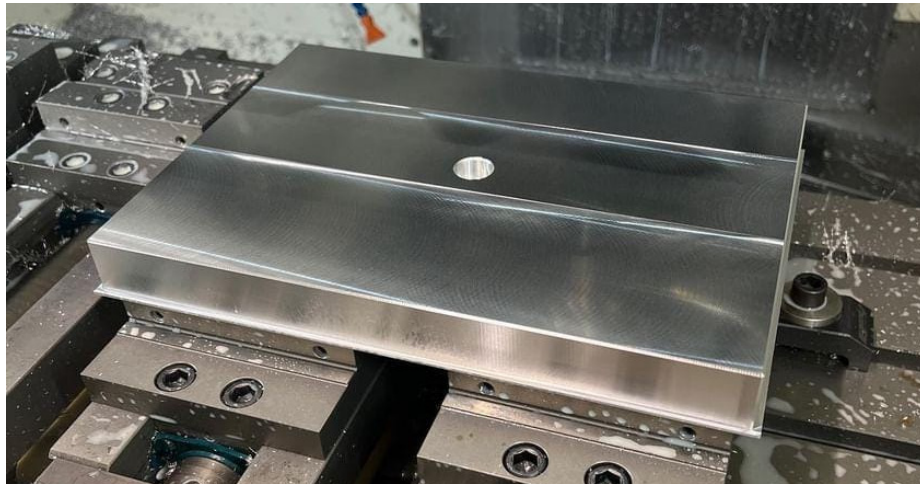
Slika 7.1.4. Izgled površine nakon operacija finog glodanja
