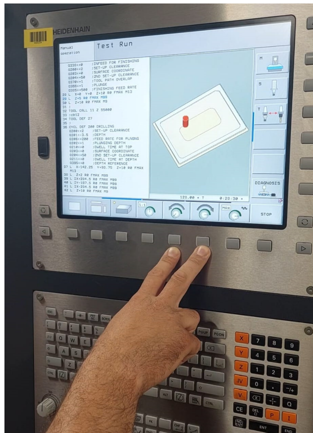
Slika 7.1. Ručno programiranje na upravljačkoj jedinici Heidenhain TNC 640
