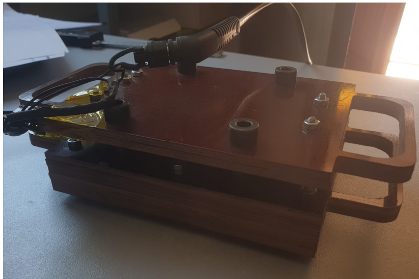
Slika 4.1.1. Prvobitno korištena naprava za sublimacijski tisak - izvana
