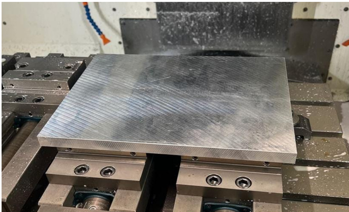
Slika 7.1.8. Izgled stegnutog sirovca za izradu pozicije 2
