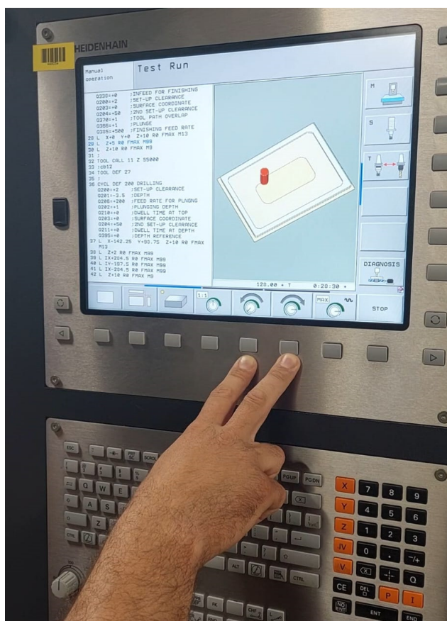
Slika 7.1. Ručno programiranje na upravljačkoj jedinici Heidenhain TNC 640
