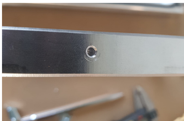
Slika 8.5. Urezivanje rupa M3 potrebnih za sklapanje zatvarača stranica
