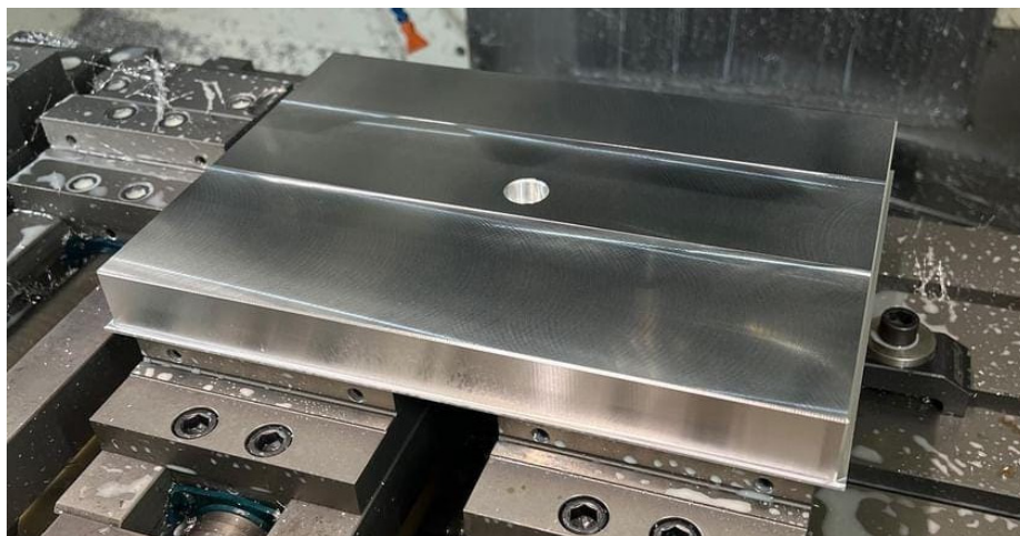
Slika 7.1.4. Izgled površine nakon operacija finog glodanja
