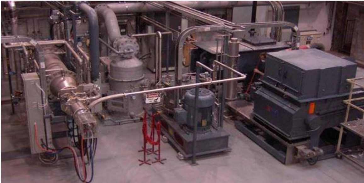
Slika 6.3.1.1 Plazma sustav za uplinjavanje
