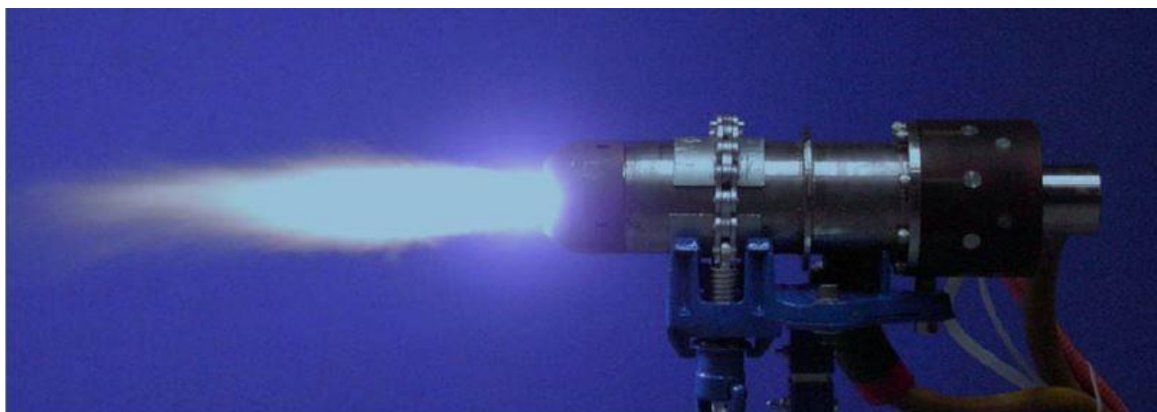
Slika 6.2.1.1 Baklja plazma sustava jačine 150 kW
