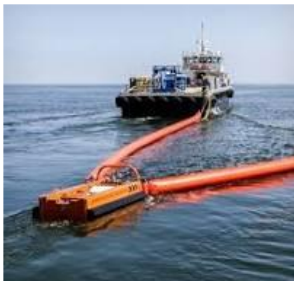
Slika 2.1.2 Uređaj za sakupljanje uljnih mrlja
